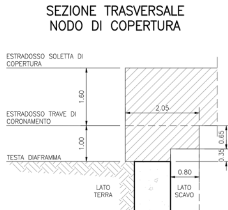
Figura 8 Sezione trasversale nodo di copertura
