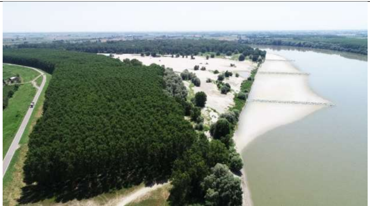
Figura 13 – Scenario evolutivo a breve termine – primi anni seguenti alla realizzazione - vista in seguito per portate inferiori a 800 \text{ m}^3/\text{s} (circa 85 giorni all'anno )
