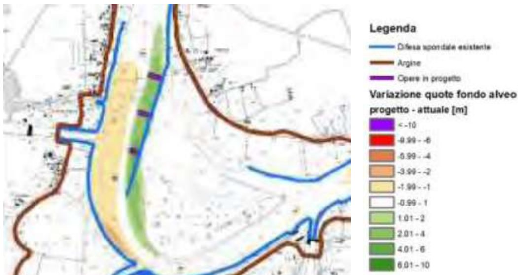
Figura 11 – Tendenza media del fondo alveo in seguito alla realizzazione delle opere
