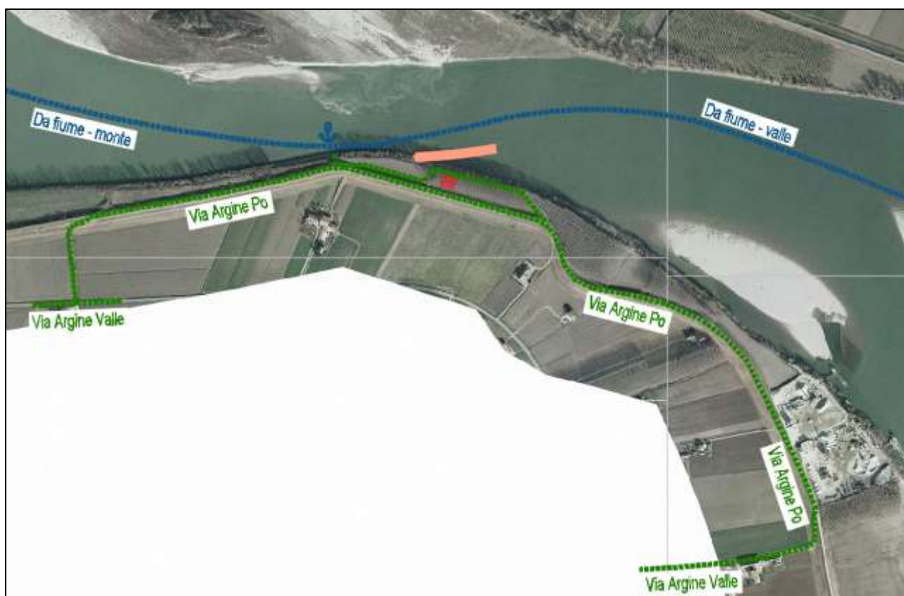
Figura 14 - Planimetria degli accessi all'area di cantiere INTERVENTO 7
