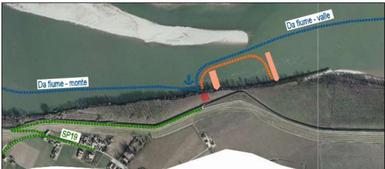
Figura 19 - Planimetria degli accessi all'area di cantiere INTERVENTO 12
