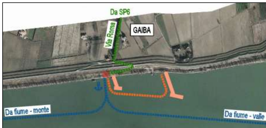
Figura 17 - Planimetria degli accessi all'area di cantiere INTERVENTO 10
