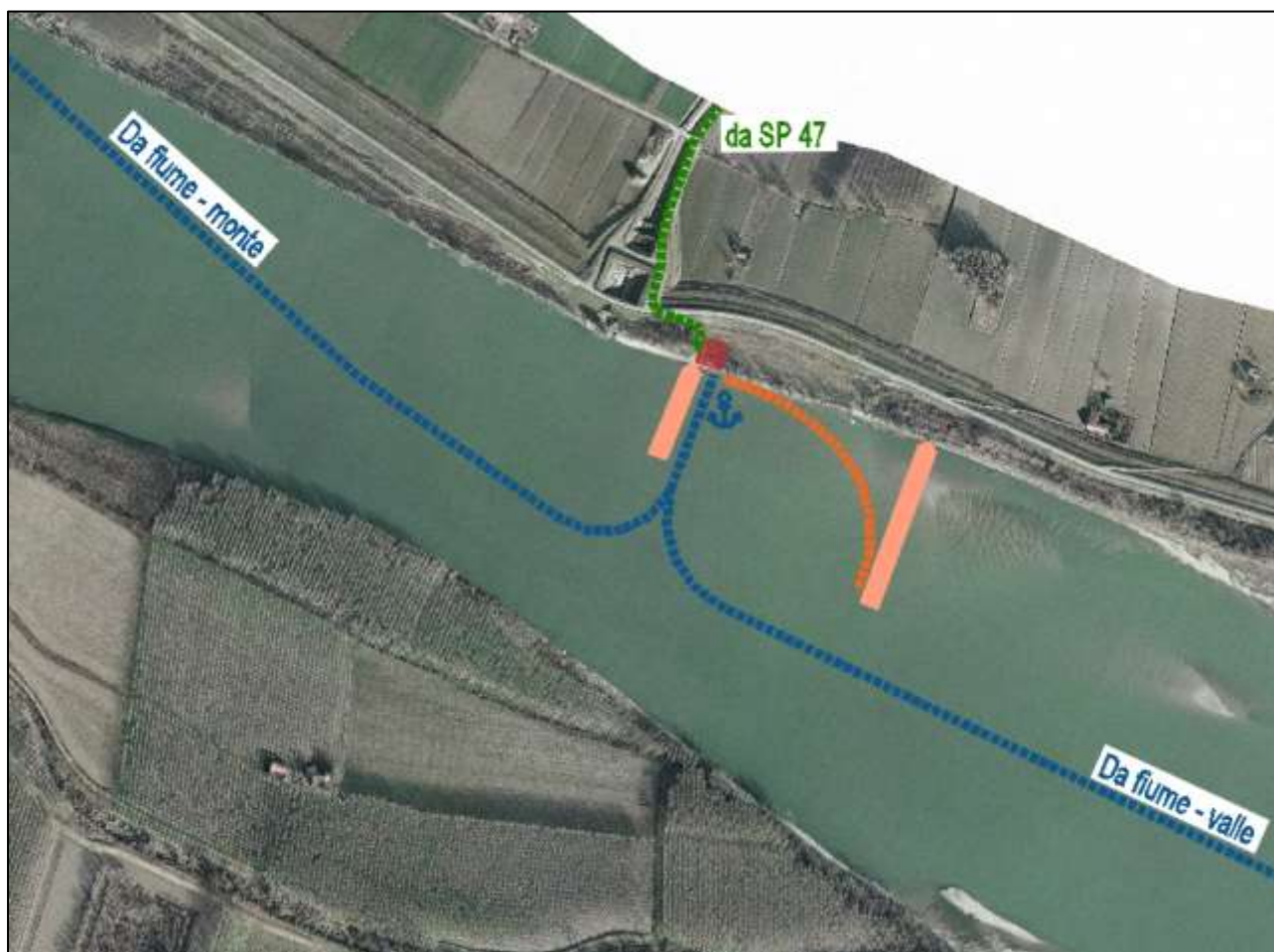
Figura 12 - Planimetria degli accessi all'area di cantiere INTERVENTO 5
