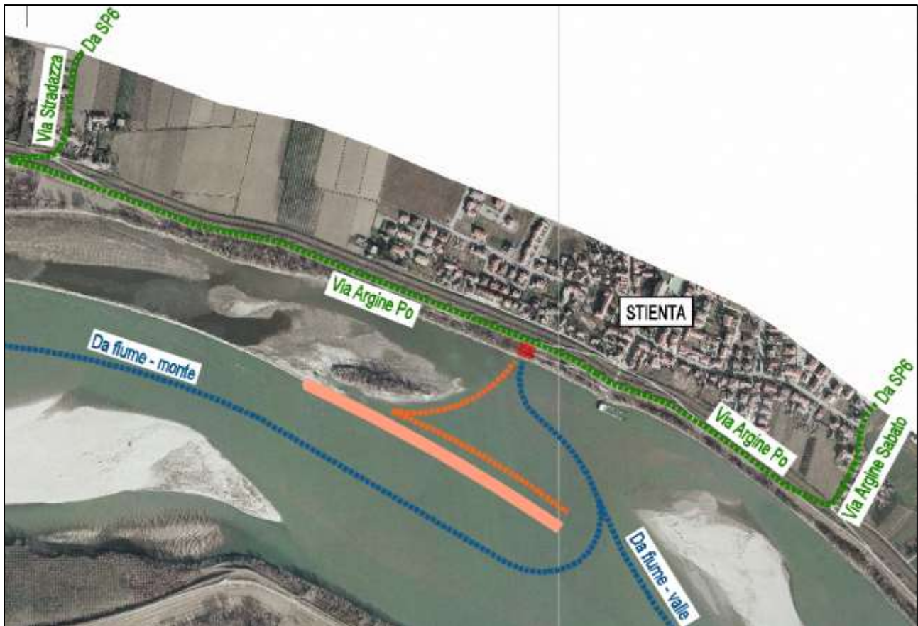
Figura 20 - Planimetria degli accessi all'area di cantiere INTERVENTO 13
