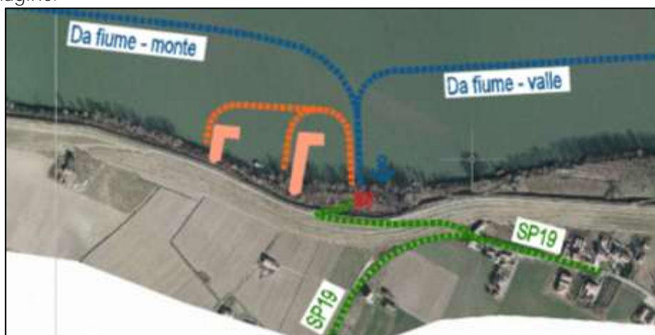
Figura 18 - Planimetria degli accessi all'area di cantiere INTERVENTO 11
