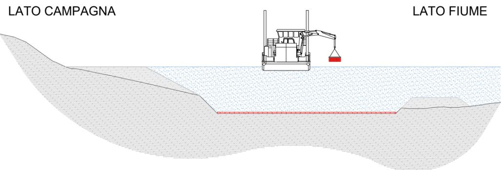
3 - FORMAZIONE DEI SACCONI A BORDO DI APPOSITO PONTONE DOTATO DI CASSONE APRIBILE, RIEMPIMENTO TRAMITE ESCAVATORE SU PONTONE E POSA DIRETTA SUL FONDO
