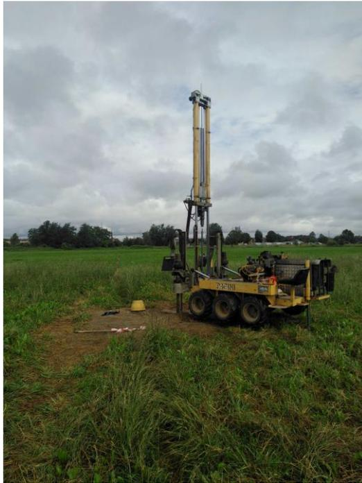
La prova penetrometrica statica, o CPT (Cone Penetration Test), è una prova eseguita per il riconoscimento di massima del profilo stratigrafico/litologico e delle proprietà meccaniche del terreno.
