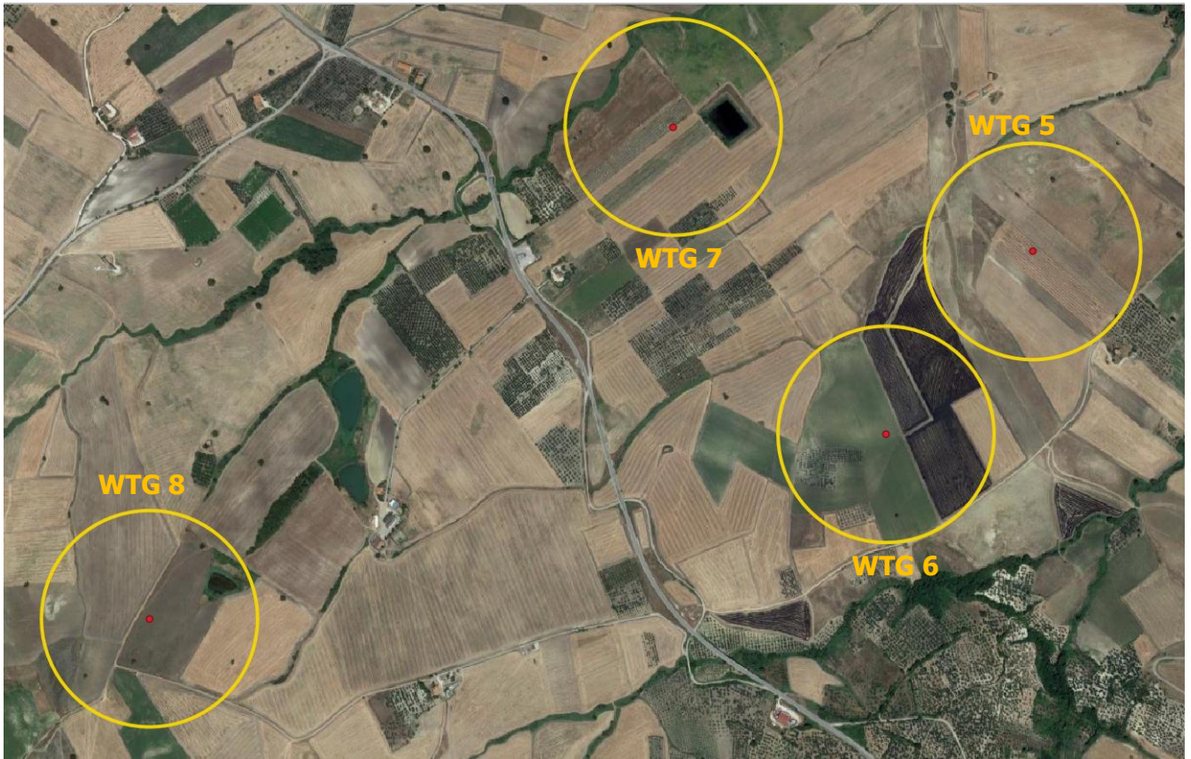
Figura 2 –Indicazione della gittata massima della pala in caso di distacco: WTG 5, WTG 6, WTG 7, WTG 8
