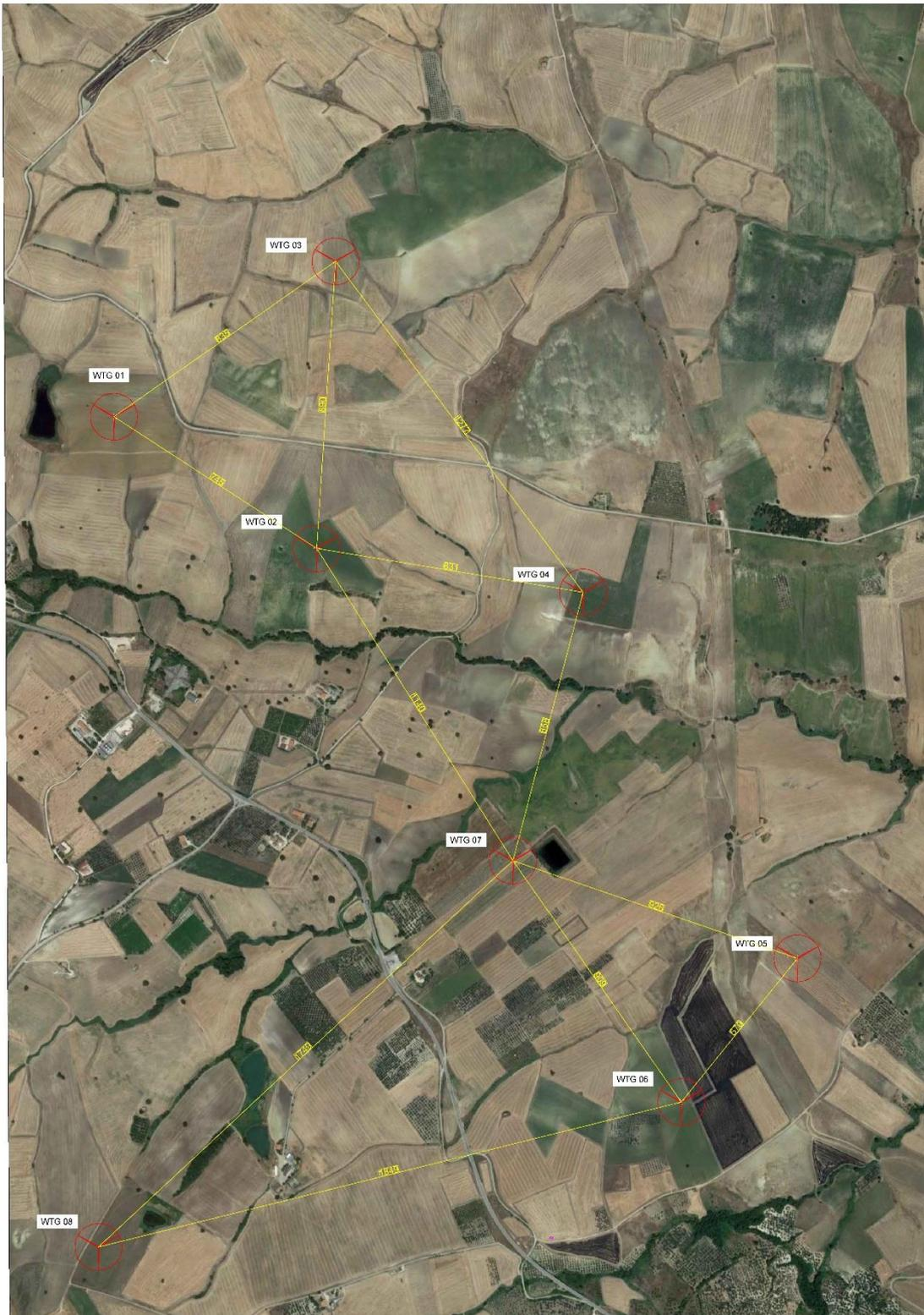
**Figura 2-6: Estratto tavola A.16.b.1.2 Planimetria con distanze aerogeneratori**
