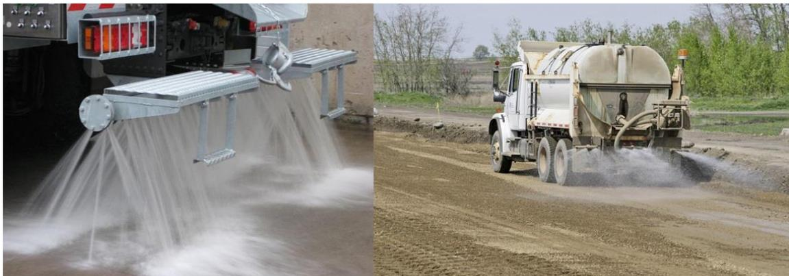
**Figura 2-47: Automezzo per la bagnatura delle piste sterrate**
