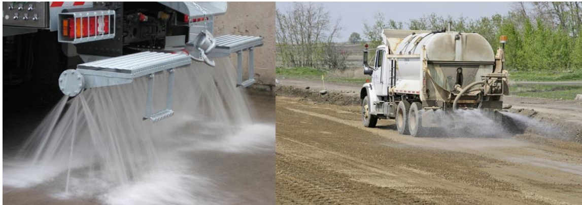
Figura 4-28: Automezzo per la bagnatura delle piste sterrate
