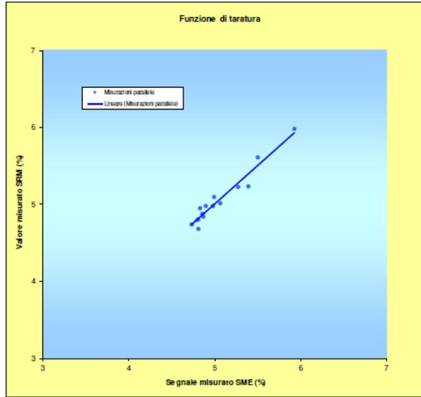
Fig.3 – Rappresentazione grafica retta di taratura O<sub>2</sub>
