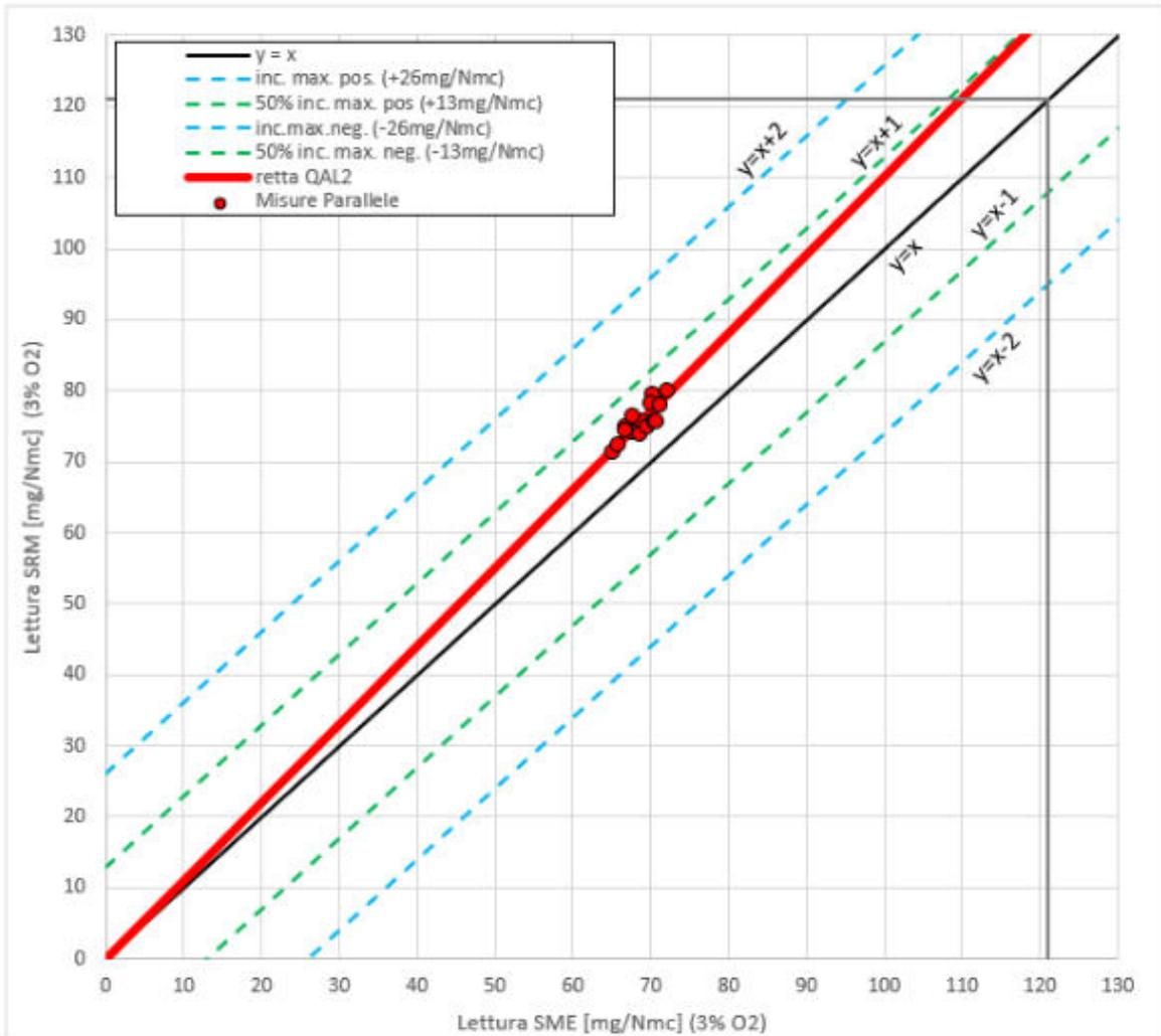
**Fig.7 –** Valutazione della retta di taratura NO<sub>x</sub> rispetto l'incertezza massima consentita
