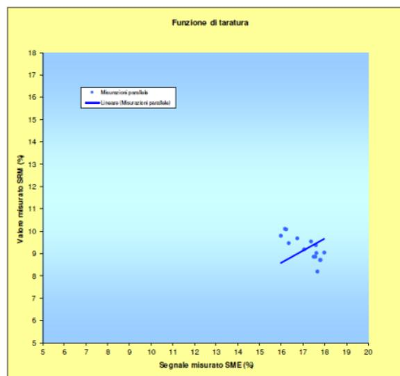
Fig.5 – Rappresentazione grafica retta di taratura NO<sub>x</sub>
