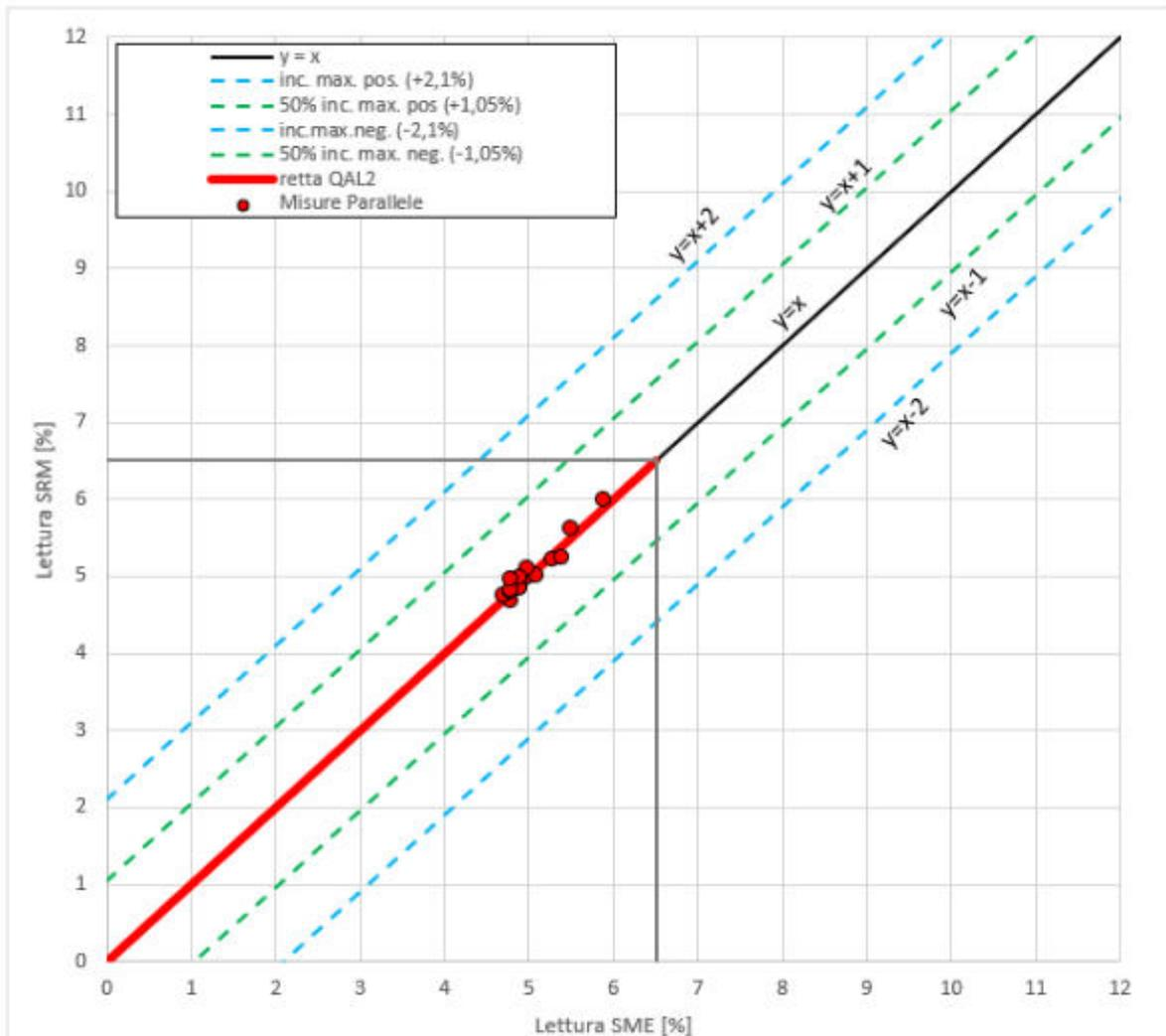
**Fig.9** – Valutazione della retta di taratura O<sub>2</sub> rispetto l'incertezza massima consentita
