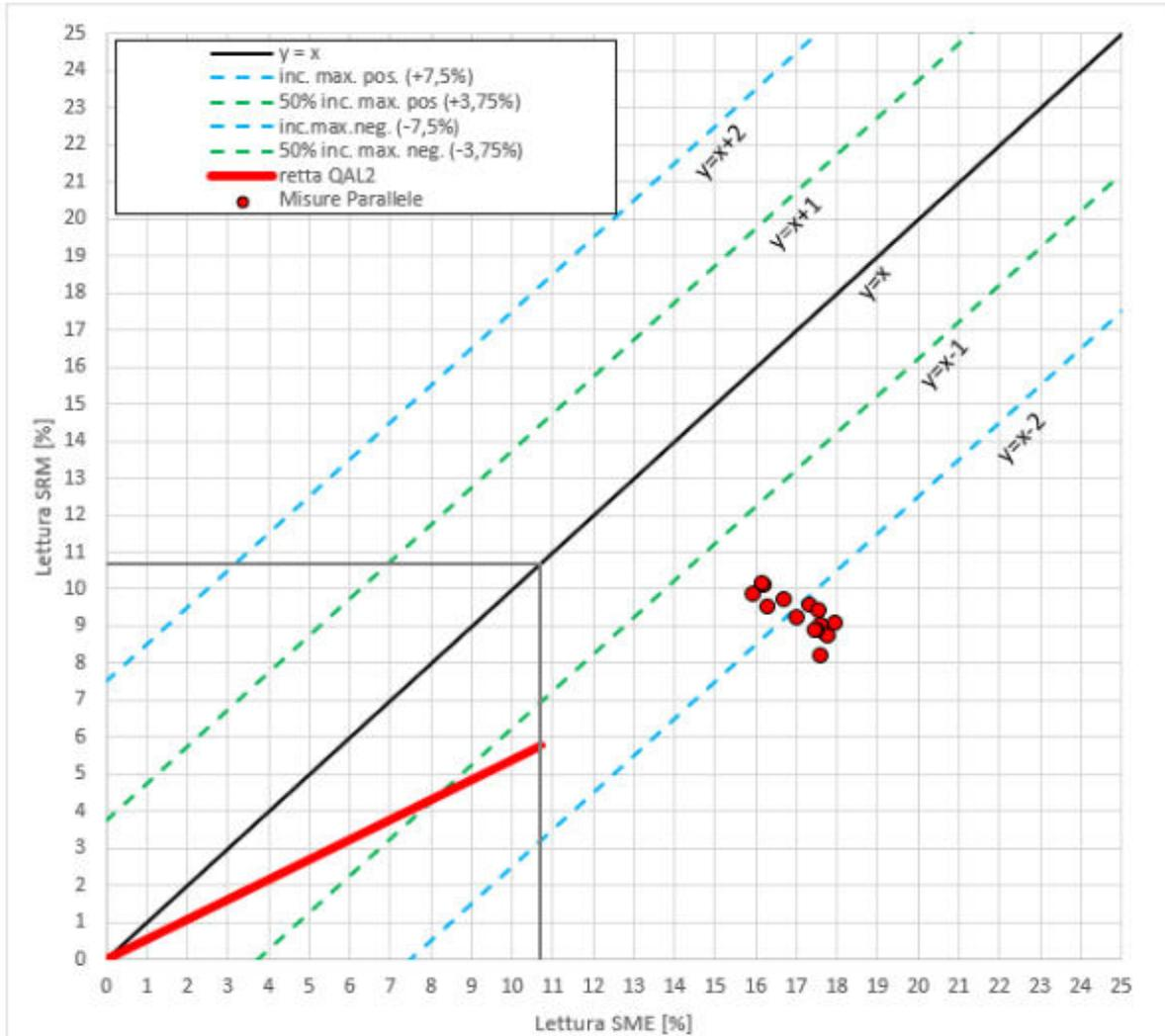
**Fig.10** – Valutazione della retta di taratura Umidità rispetto l'incertezza massima consentita
