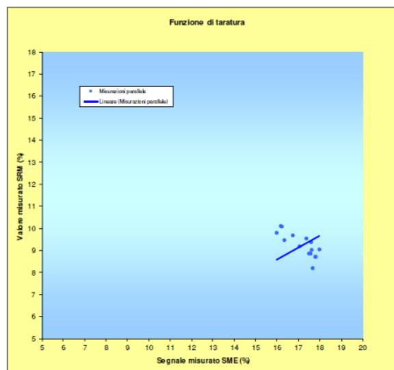
Fig.6 – Rappresentazione grafica retta di taratura umidità
