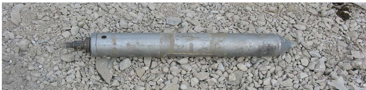
Campionatore nella posizione di infissione a pressione
