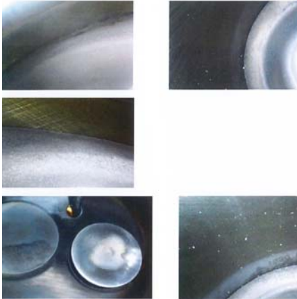
Particolare della verifica boroscopica sul motore DGE2 che mostra in alcuni cilindri i fenomeni di incrostazione metalliche
