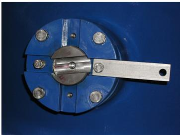
**LOCKING DEVICE:** sistema di bloccaggio dell'albero posteriore. Permette lo smontaggio e la manutenzione del riduttore a vite senza fine, bloccando la lente nella posizione di apertura o di chiusura, in piena sicurezza, senza dover causare il fuori servizio dell'impianto o lo svuotamento della condotta.
