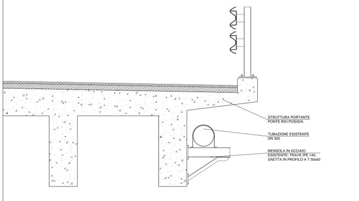
AR<sub>AB2</sub> - SEZIONE TRASVERSALE - POST OPERAM
