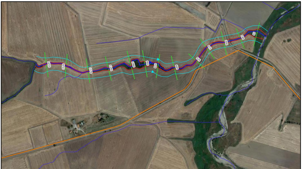
Figura 18 - Sezioni trasversali del river 17
