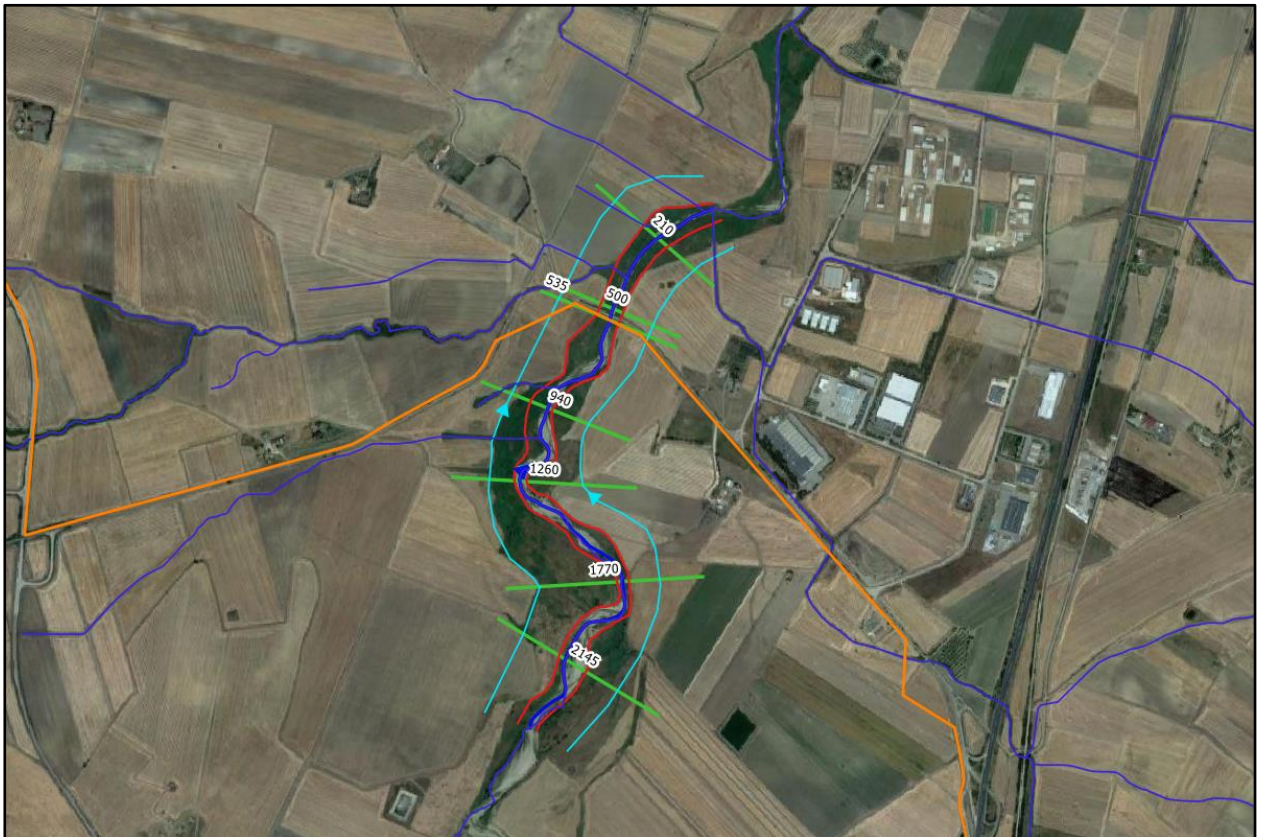
Figura 23 - Sezioni trasversali del river 22
