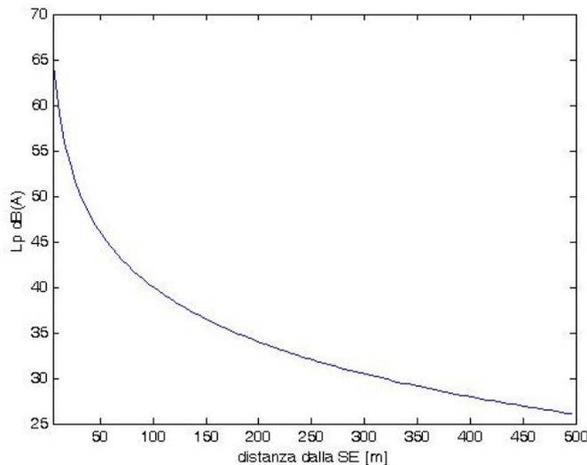
Di seguito, note le distanze dei ricettori dalla **SE** (Sorgente di Emissione) e le componenti dei livelli di pressione sonora, si determina l' $L_p(A)$  dovuto alle varie sorgenti di emissione presso il ricettore e in prossimità dell'aerogeneratore oggetto dell'intervento.
