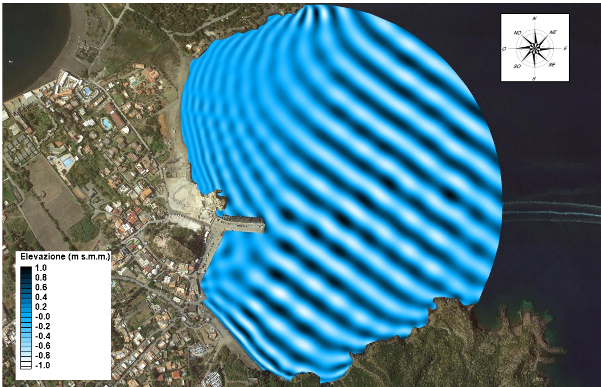
Figura 6.4 - TEST 1: mareggiata di Grecale da NNE (35°N), andamento delle creste
