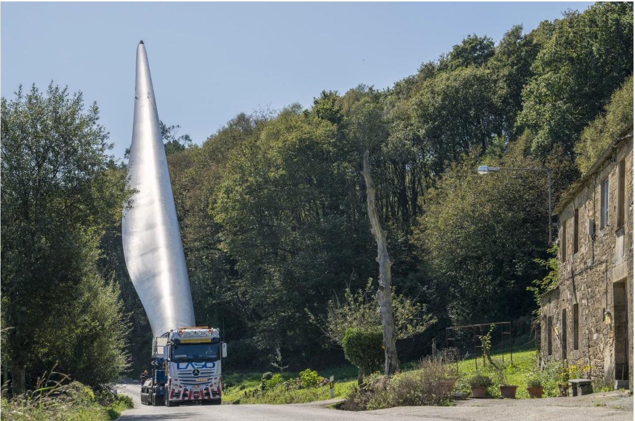
Figura 4: blade lifter, utilizzator per il trasporto delle pale per aerogeneratori.
