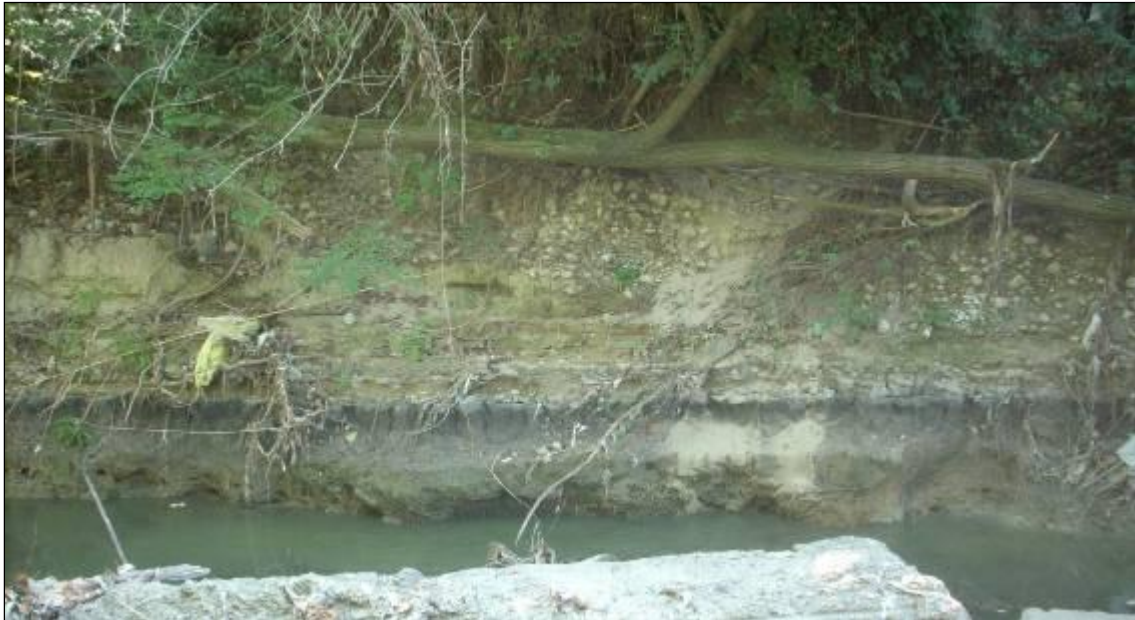
Fig.50 - Alveo del T. Savena: scarpata fluviale a geometria subverticale di altezza 3 m circa. Si noti il contatto stratigrafico tra depositi grossolani e terreni fini grigio scuro (località Fondo Mori).
