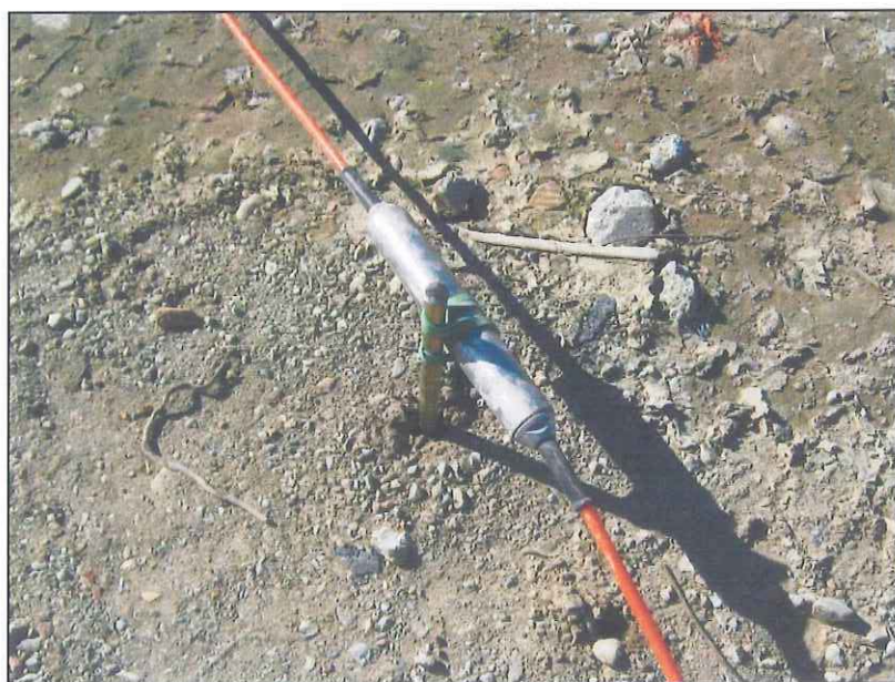
Elettrodo collegato ad un picchetto in ottone
