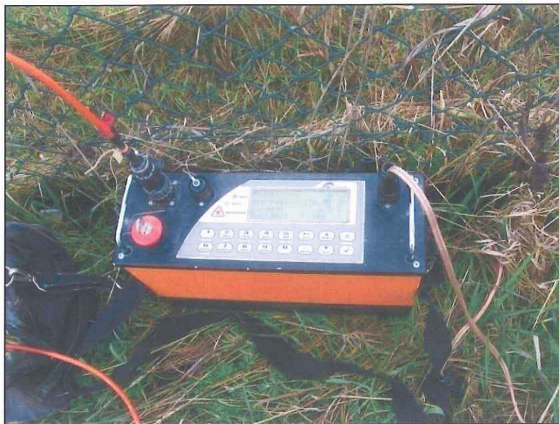
Georesistivometro multielettrodo ARES 200E
