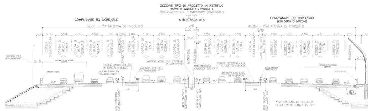
Figura 5-6 Sezione di progetto tra le progressive km 14+150 e il km 16+200
