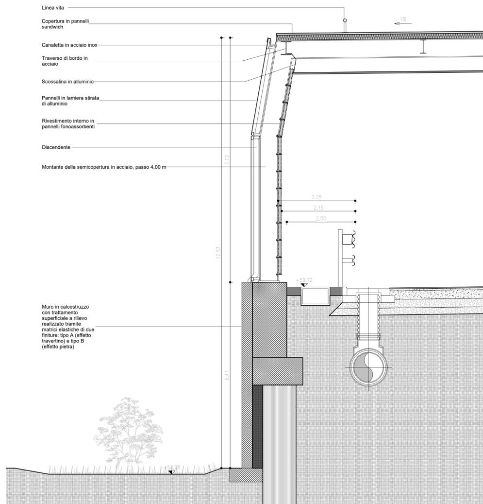
1) Dettaglio su muro in calcestruzzo con rilievo a matrici
