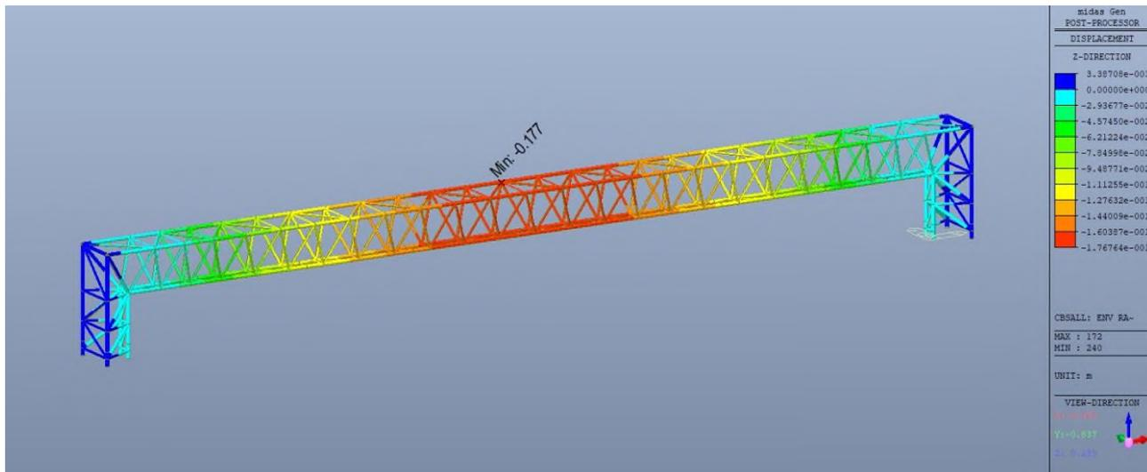
Figura 7-52 - Spostamenti verticali massimi
