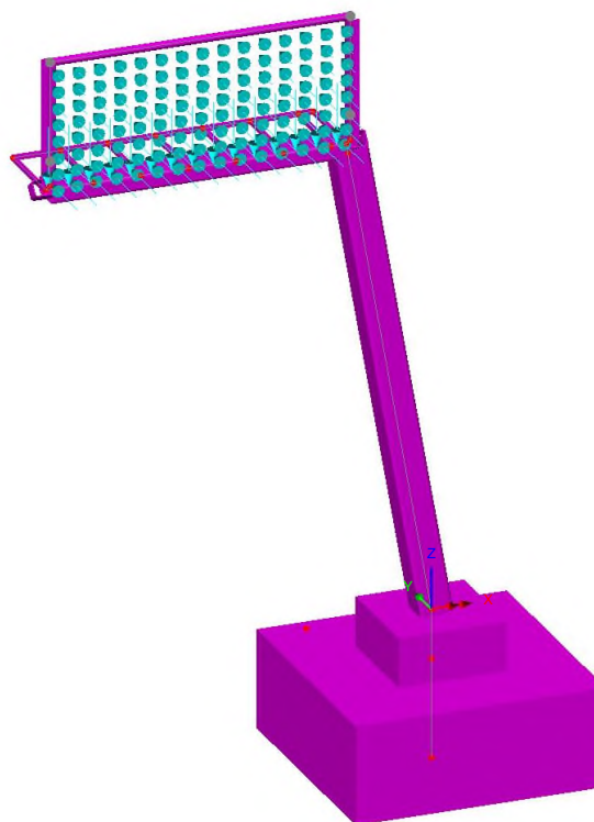
Figura 2-7. Azione di Buffeting - Corsia 1
