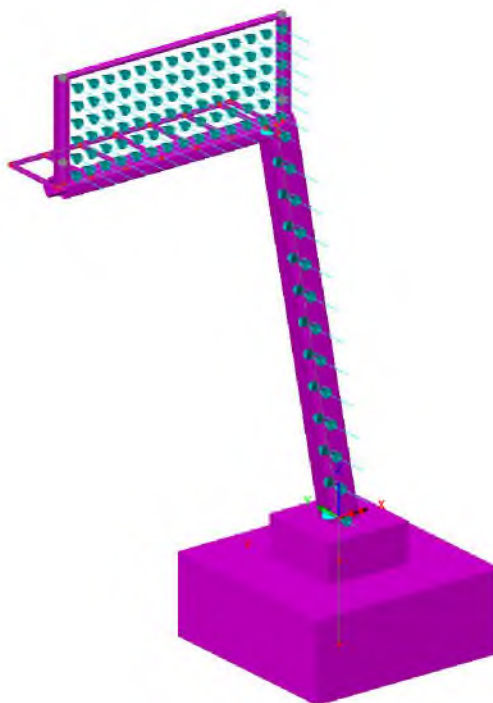
Figura 2-3. Azioni del vento sulla struttura
