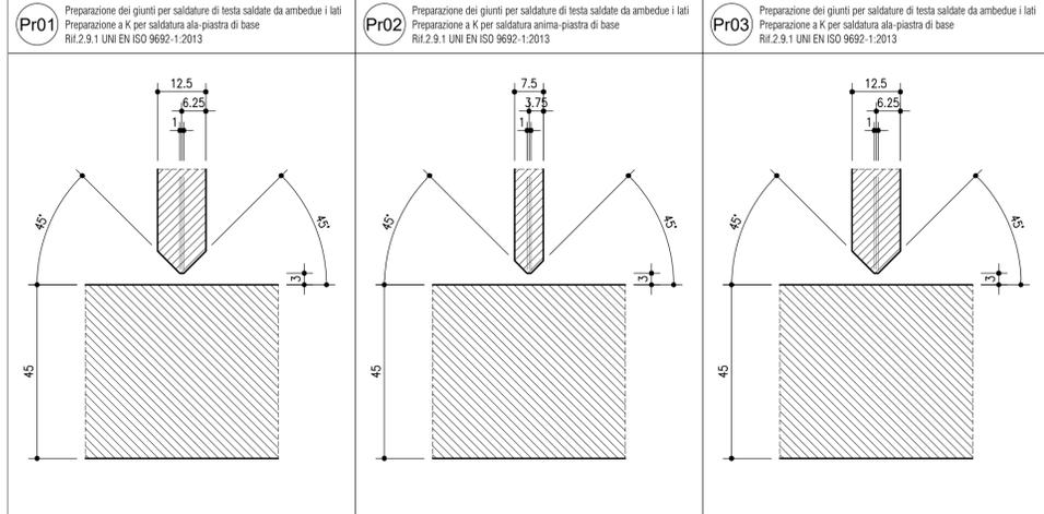
Preparazione dei giunti per saldature di testa saldate da ambedue i lati, secondo UNI EN ISO 9692-1:2003
