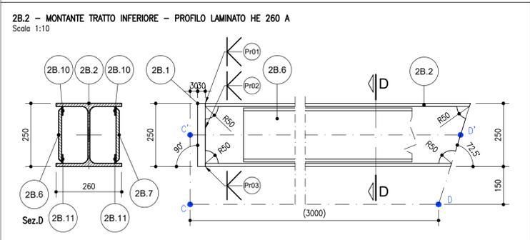
ASSEMBLAGGIO DEL MONTANTE SPECIALE PER CORPO ILLUMINANTE SU BARRIERA DI MITIGAZIONE ACUSTICA TIPO 2 - TRATTO DI BORDO
