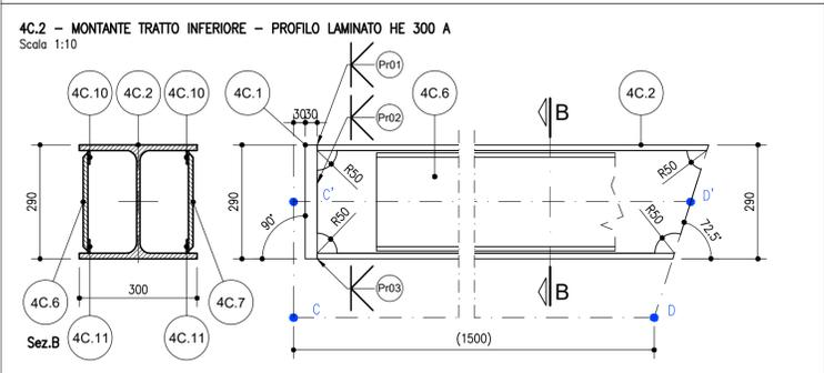
ASSEMBLAGGIO DEL MONTANTE SPECIALE PER CORPO ILLUMINANTE SU BARRIERA DI MITIGAZIONE ACUSTICA TIPO 4 - TRATTO CORRENTE
