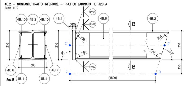
ASSEMBLAGGIO DEL MONTANTE SPECIALE PER CORPO ILLUMINANTE SU BARRIERA DI MITIGAZIONE ACUSTICA TIPO 4 - TRATTO DI BORDO
