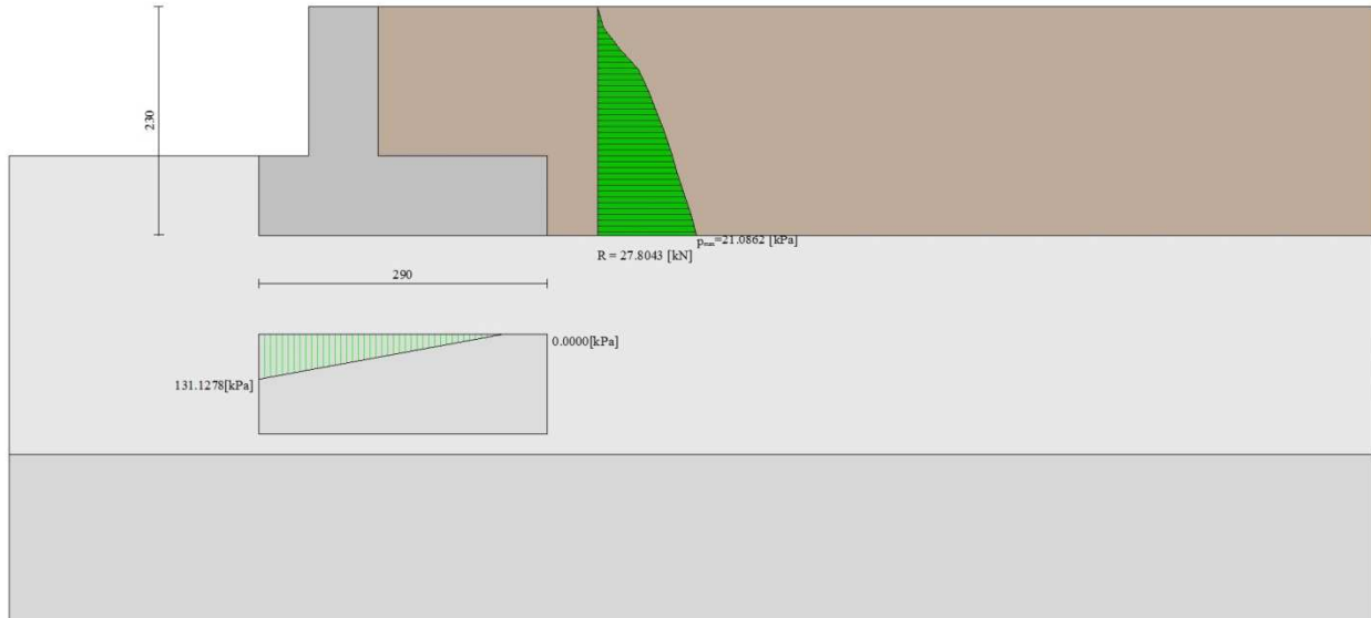
Fig. 4 - Diagramma delle pressioni (combinazione statica) (Combinazione n° 1)
