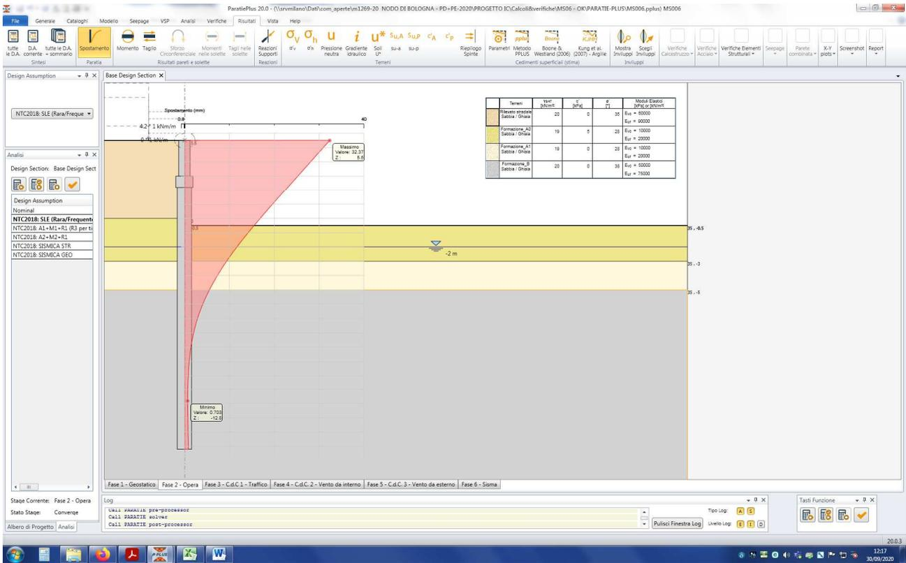
Figura n.8.7 – Spostamenti fase 2 fine costruzione
