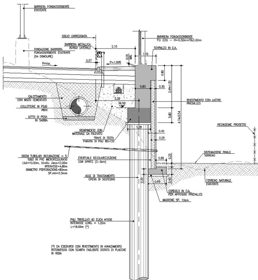
Figura 1-1 - Sezione tipo opera di sostegno MS006
