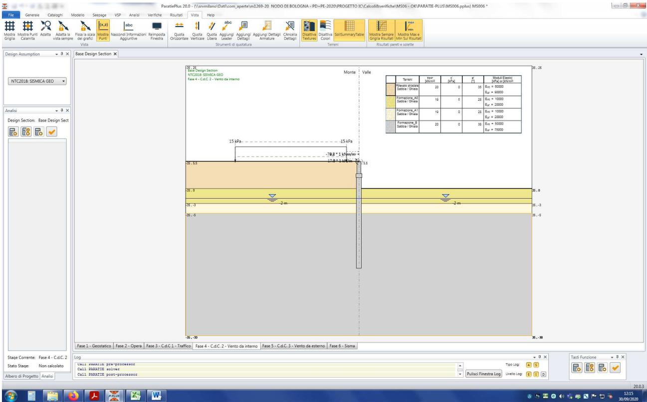
Figura n.8.4 - FASE 4 - C.d.C. 2 – Azione sulle FOA (vento da interno)
