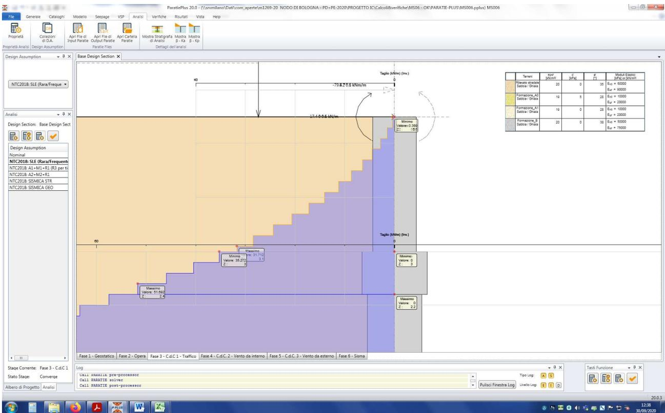
Figura n.8.18 – Azione di taglio - Inviluppo SLV
