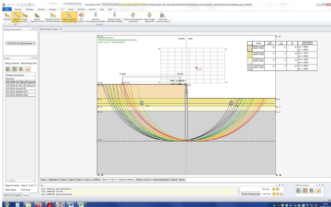
Figura n.9.1 – Analisi di stabilità – Configurazione finale – Verifica statica
