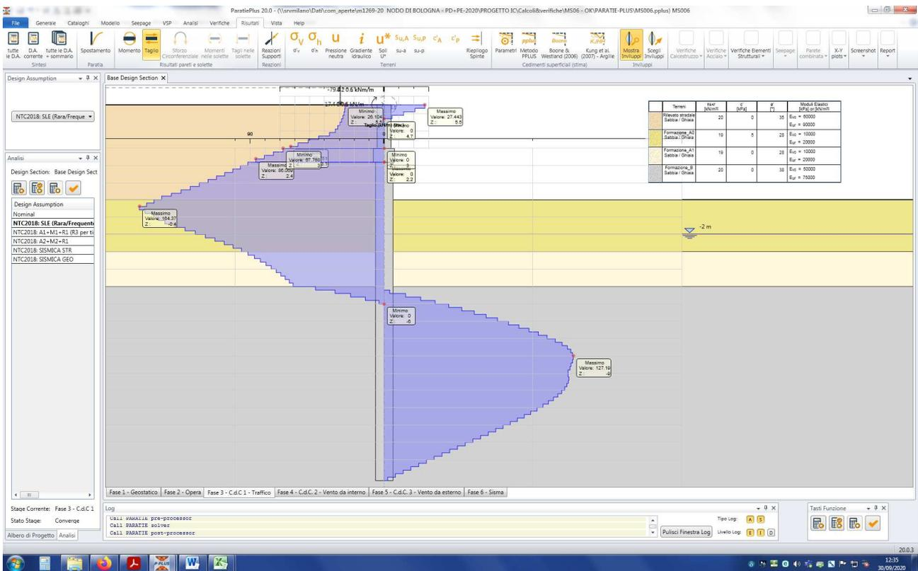
Figura n.8.11 – Azione di taglio - Involuppo SLU
