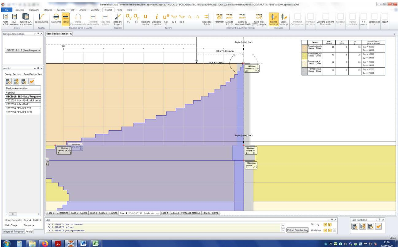
Figura n.8.18 – Azione di taglio - Involuppo SLV
