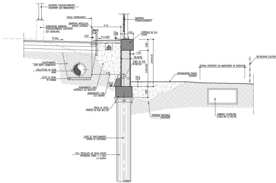
Figura 1-1. Sezione tipo opera di sostegno MS07
