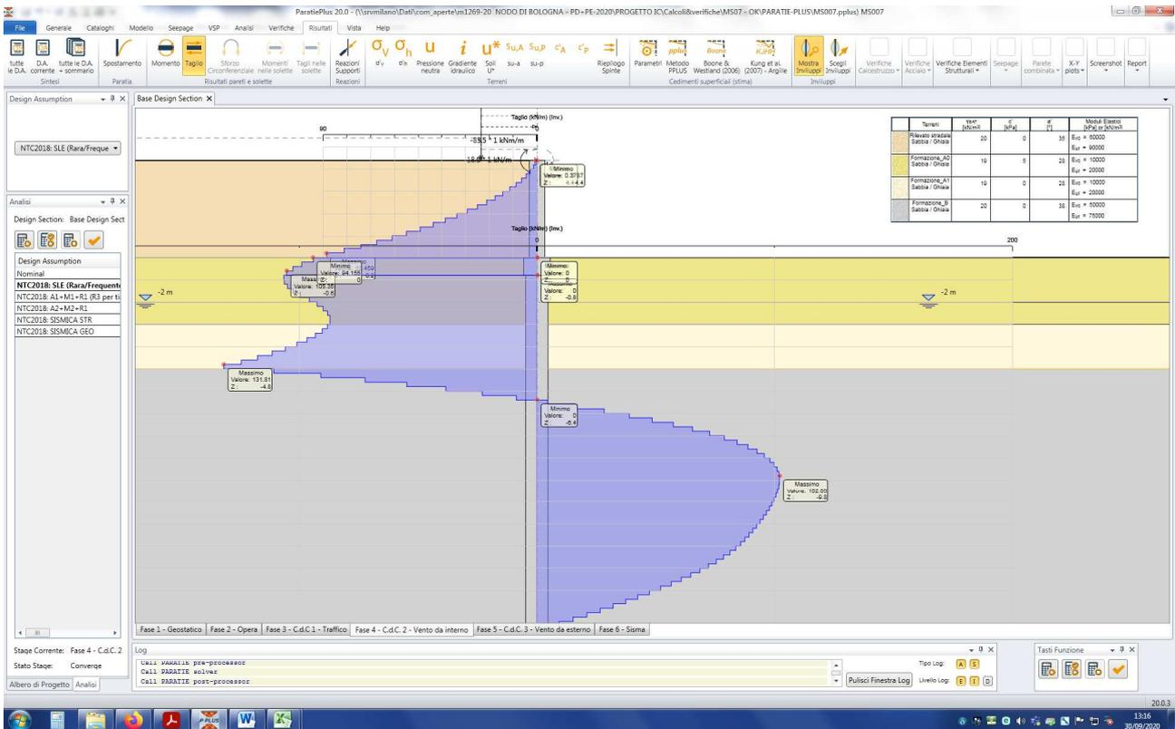
Figura n.8.13 – Azione di taglio - Involuppo SLV
