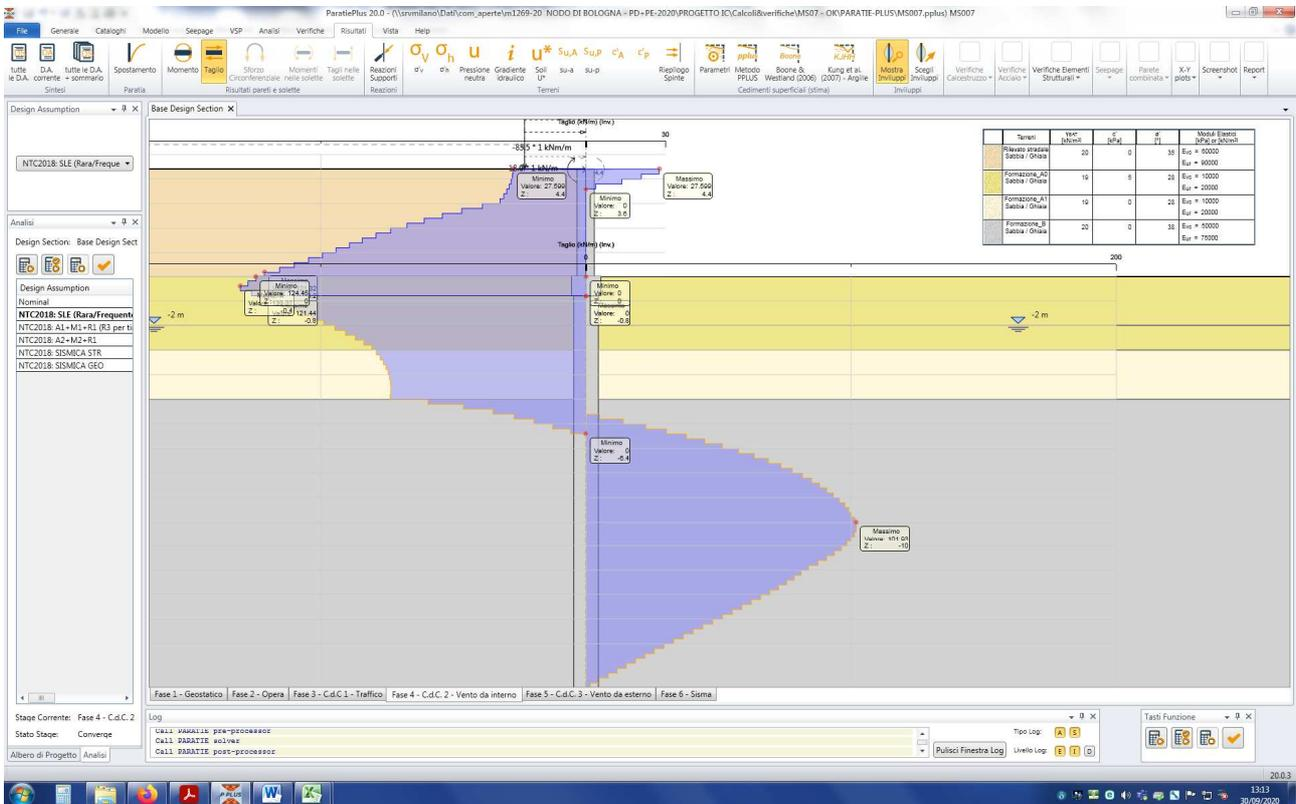
Figura n.8.11 – Azione di taglio - Involuppo SLU
