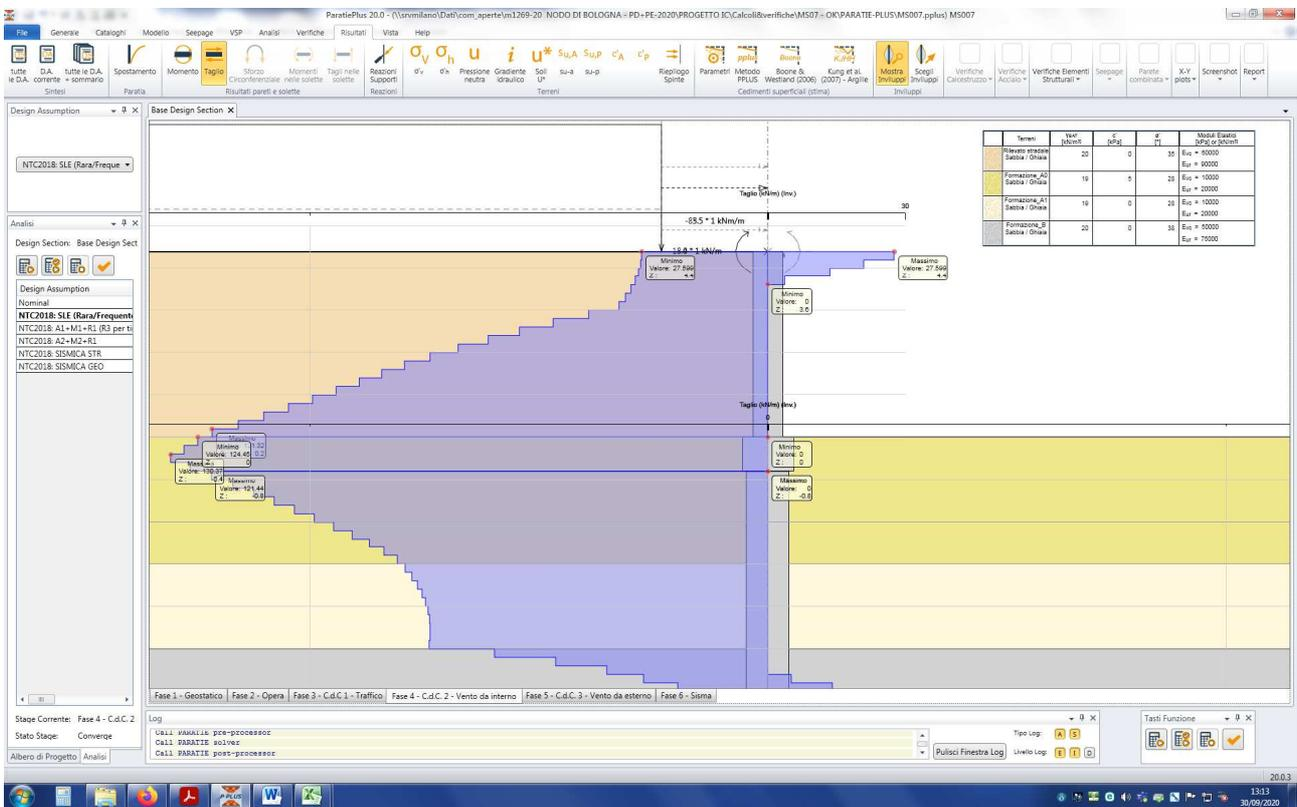
Figura n.8.16 – Azione di taglio - Involuppo SLU
