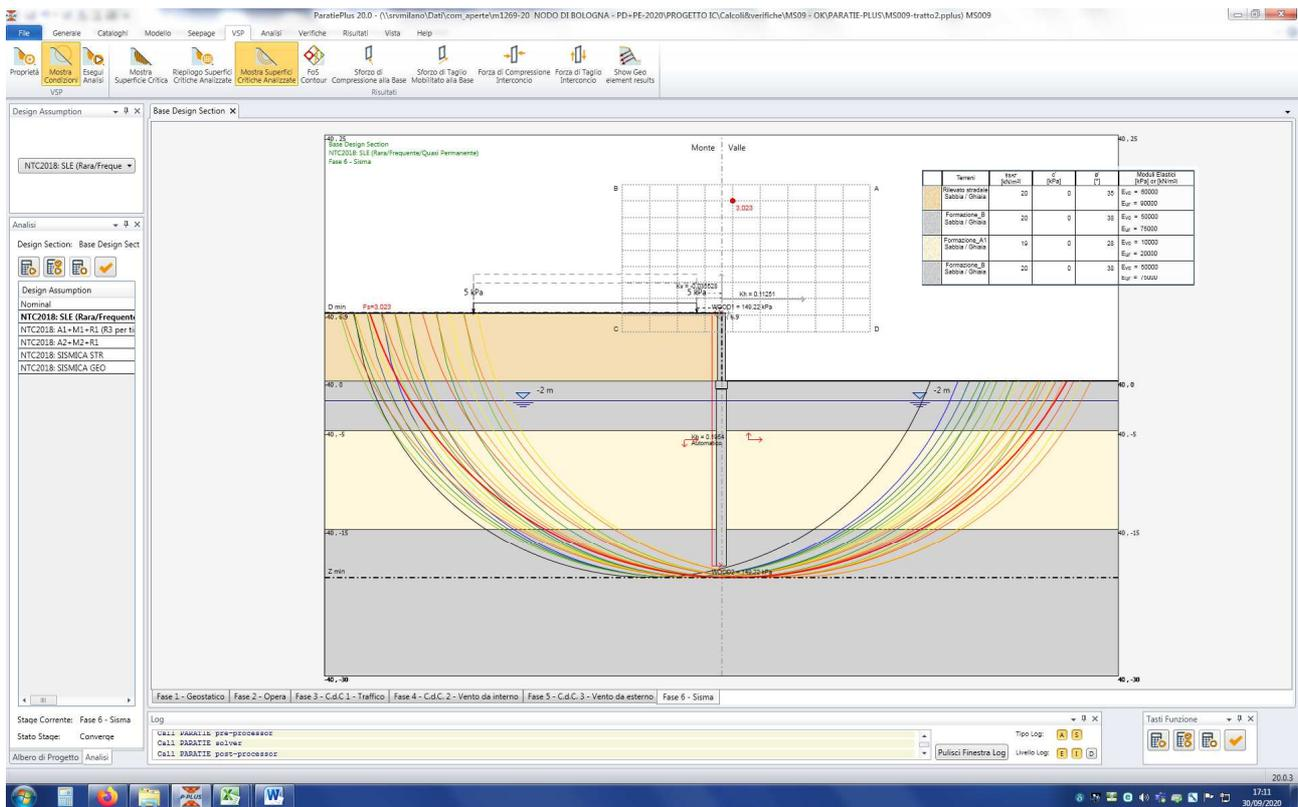
Figura n.9.2 – Analisi di stabilità – Configurazione finale – Verifica sismica
