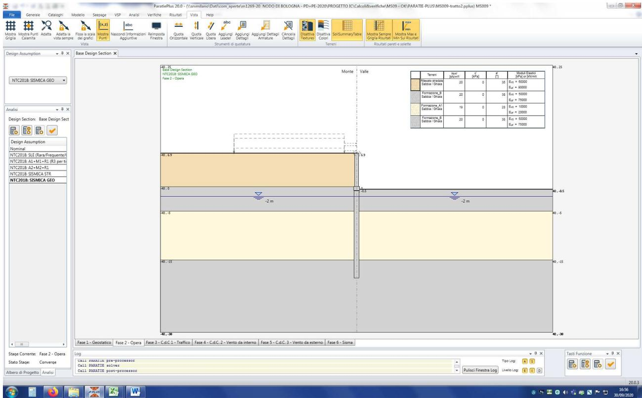
Figura n.8.2 - FASE 2 - Realizzazione dell'opera di sostegno con riprofilatura a valle
