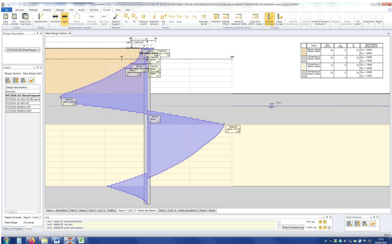
Figura n. 10.11 – Azione di taglio - Involuppo SLU
