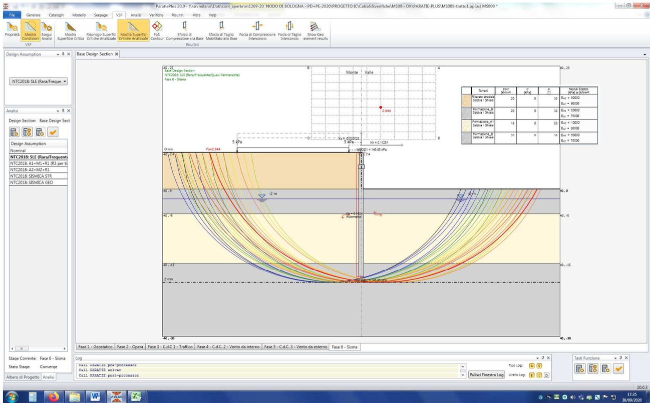
Figura n.11.2 – Analisi di stabilità – Configurazione finale – Verifica sismica
