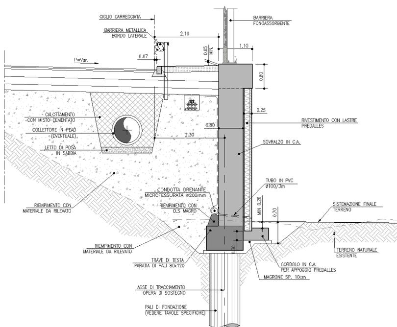
Figura 1-2. Sezione tipo opera di sostegno MS009 – Tratto 2
