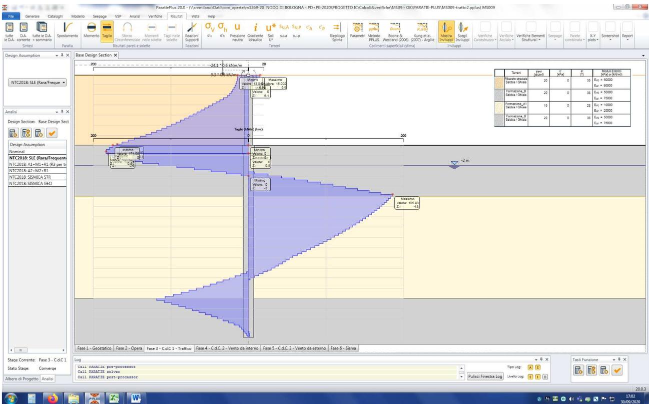
Figura n.8.11 – Azione di taglio - Inviluppo SLU
