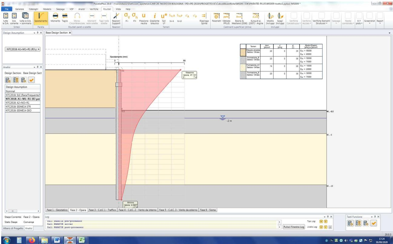
Figura n.10.7 – Spostamenti fase 2 fine costruzione
