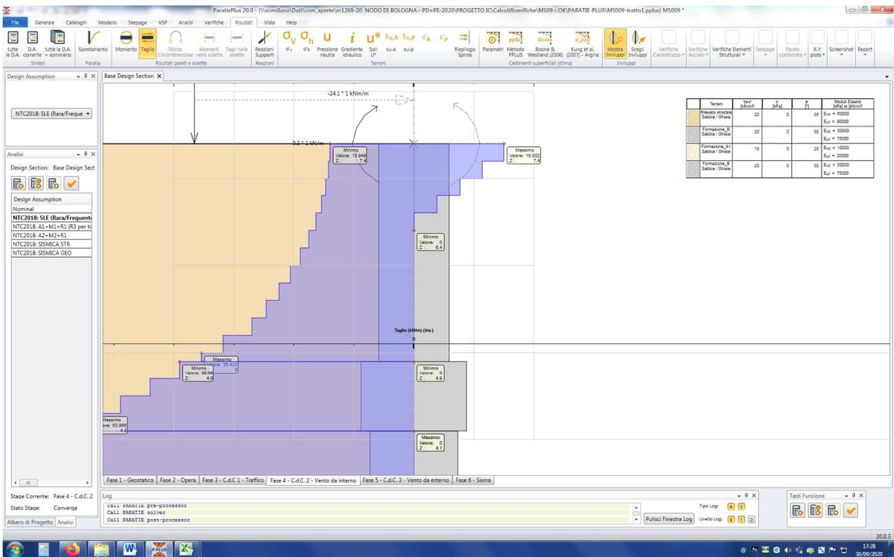
Figura n.10.16 – Azione di taglio - Involuppo SLU
