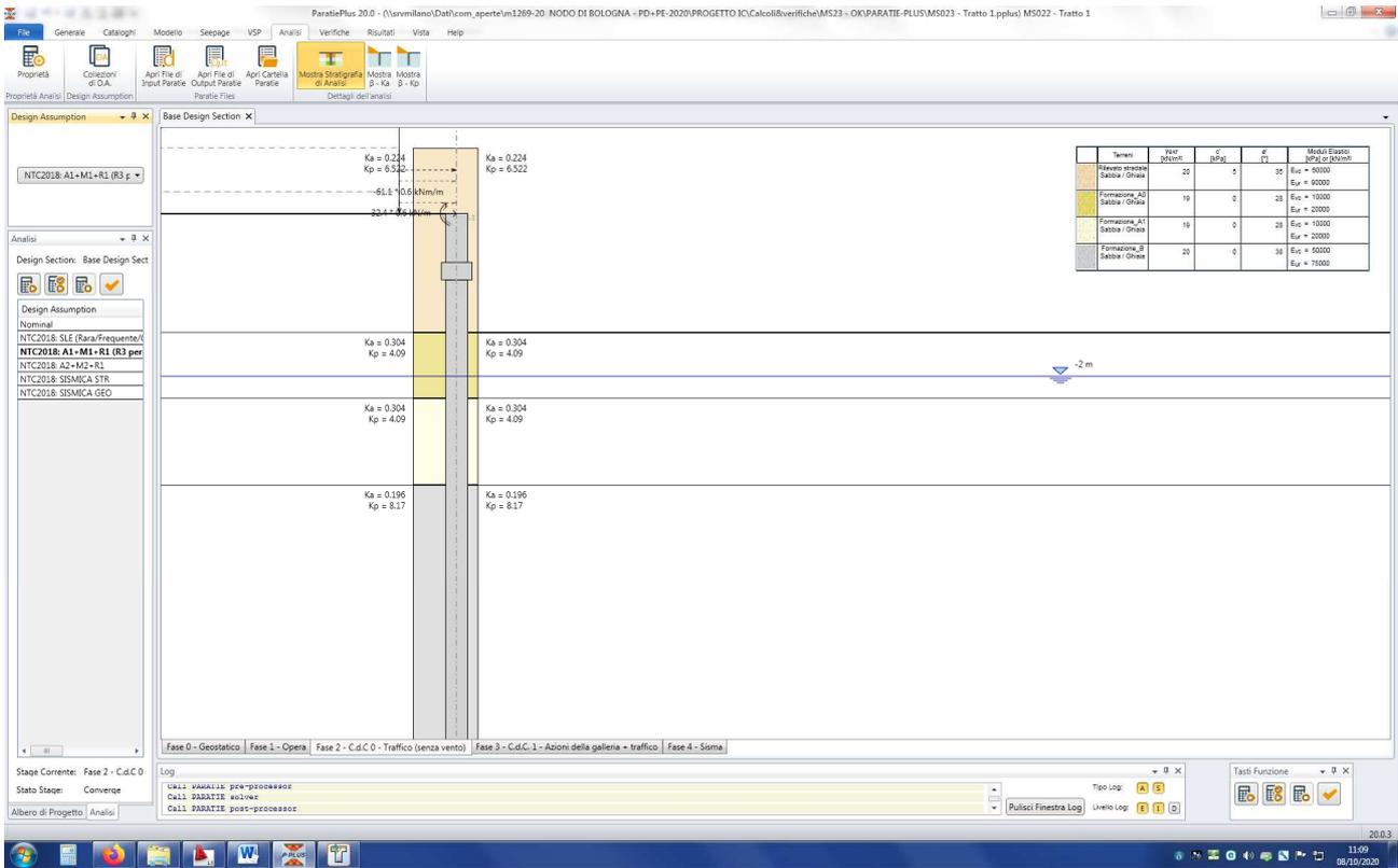
Figura n.7.1 – Verifiche statiche STR - Coefficienti di spinta
