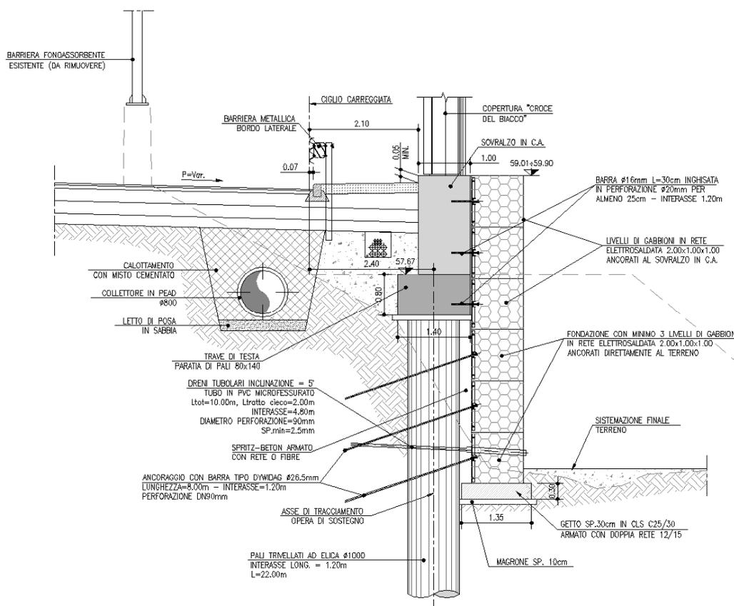
Figura 1-1. Sezione tipo opera di sostegno MS023 e MS027 – Tratto 1
