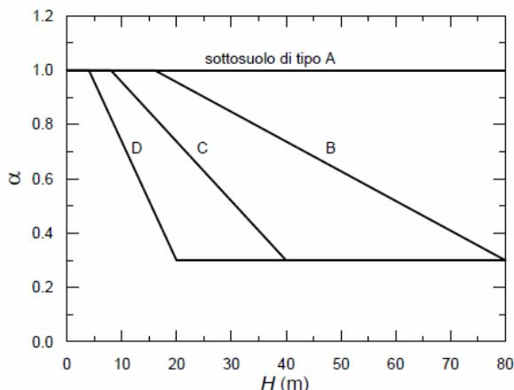
Fig. 7.11.2 - Diagramma per la valutazione del coefficiente di deformabilità α
