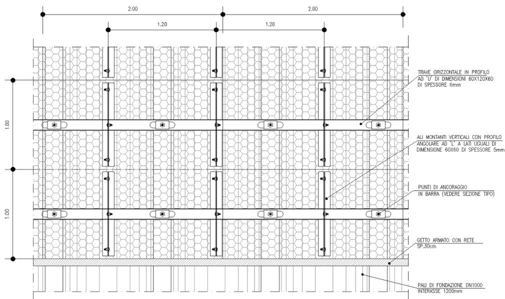
Figura 1-3. Muro MS023 e MS027 – Rivestimento in gabbioni
