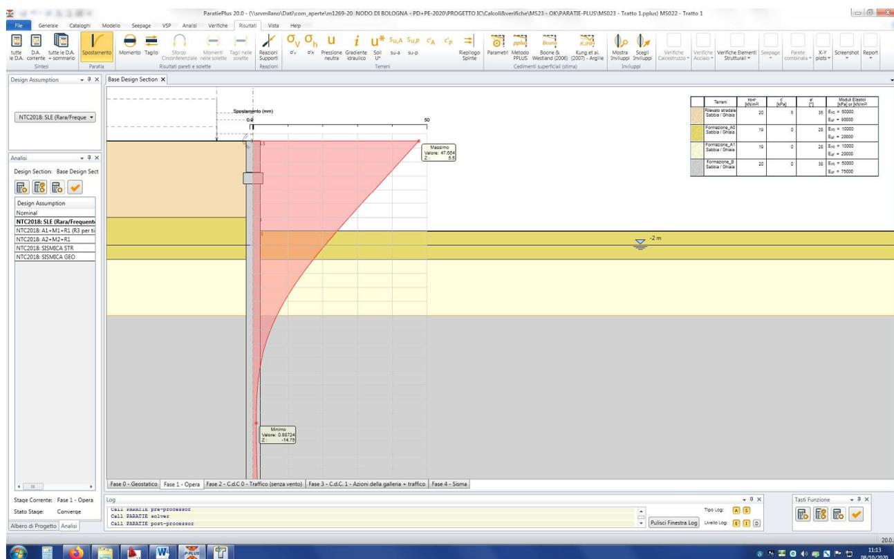
Figura n.8.5 – Spostamenti fase 2 fine costruzione
