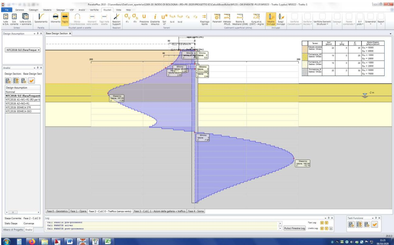
Figura n.8.11 – Azione di taglio - Involuppo SLV
