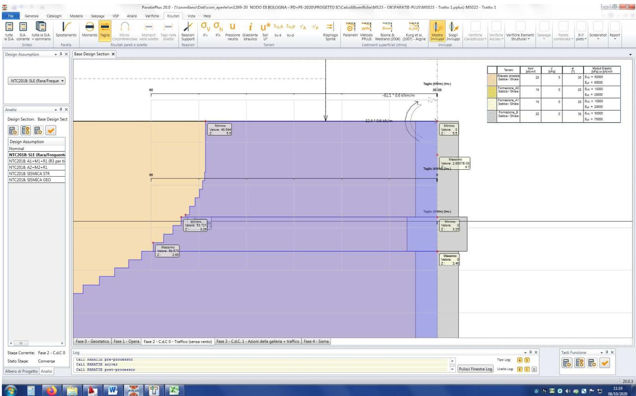
Figura n. 8.14 – Azione di taglio - Involuppo SLU
