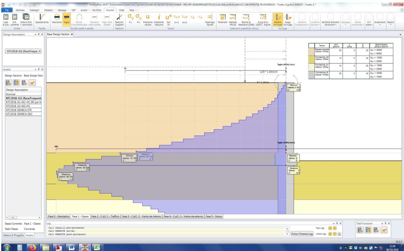
Figura n. 10.18 – Azione di taglio - Inviluppo SLV
