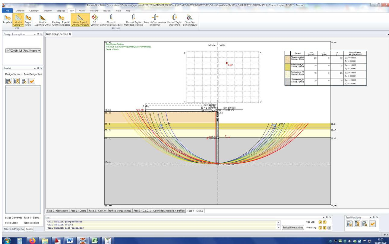
Figura n.9.2 – Analisi di stabilità – Configurazione finale – Verifica sismica
