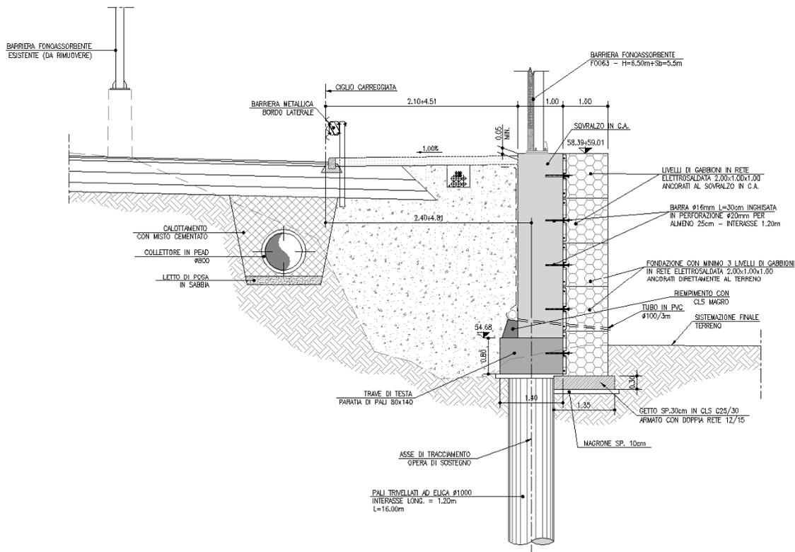
Figura 1-2. Sezione tipo opera di sostegno MS023 – Tratto 2
