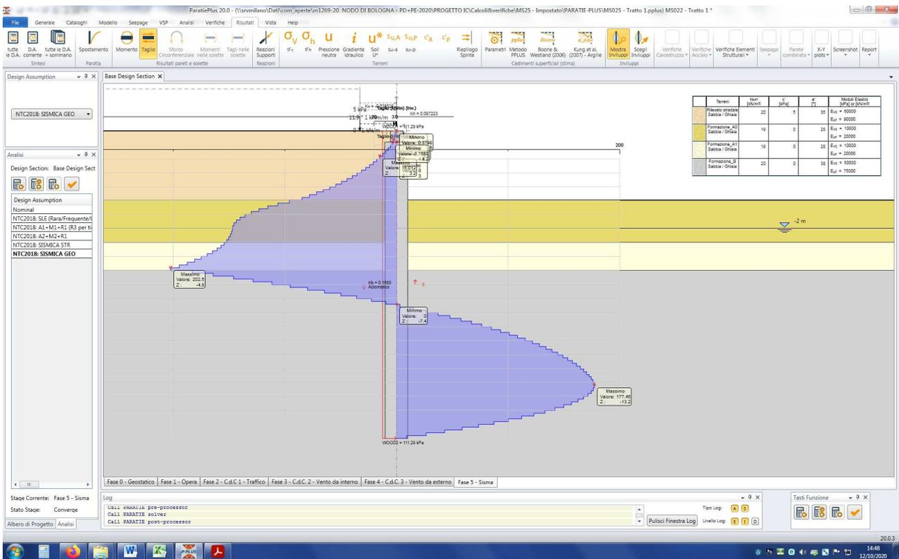
Figura n.8.13 – Azione di taglio - Involuppo SLV
