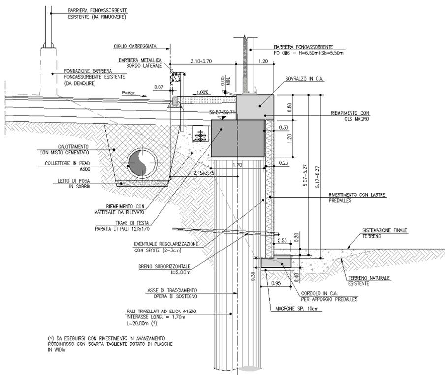
Figura 1-1. Sezione tipo opera di sostegno MS025 – Tratto 1
