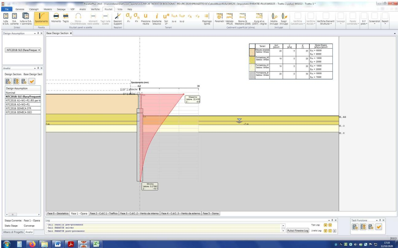
Figura n.10.7 – Spostamenti fase 2 fine costruzione
