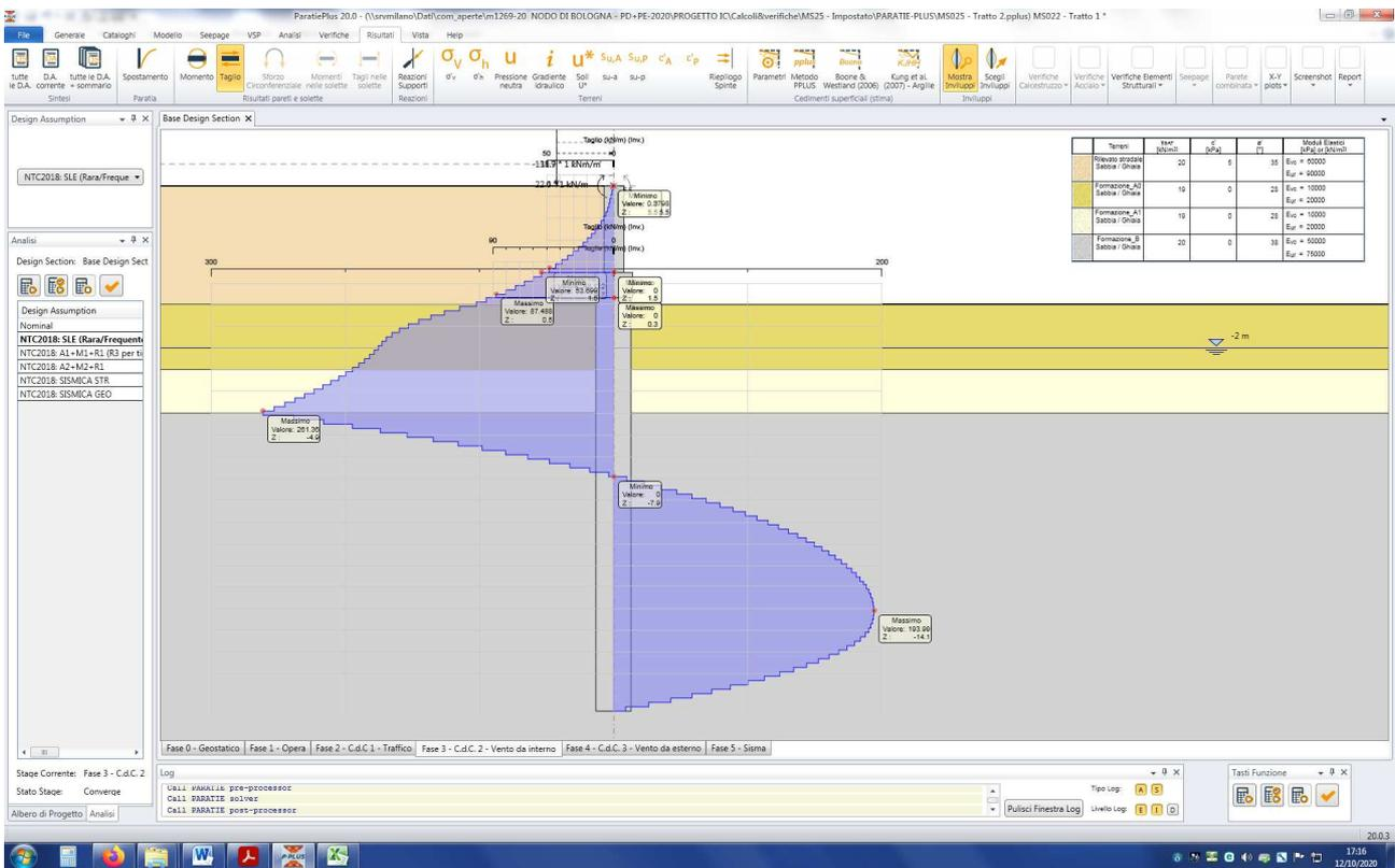
Figura n. 10.13 – Azione di taglio - Involuppo SLV
