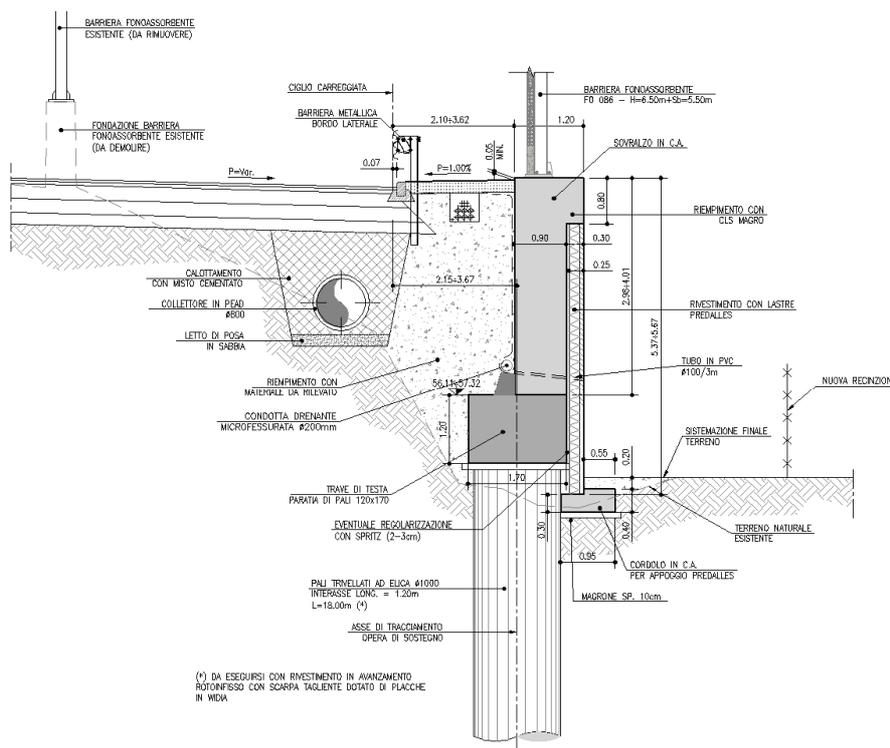
Figura 1-2. Sezione tipo opera di sostegno MS025 – Tratto 2
