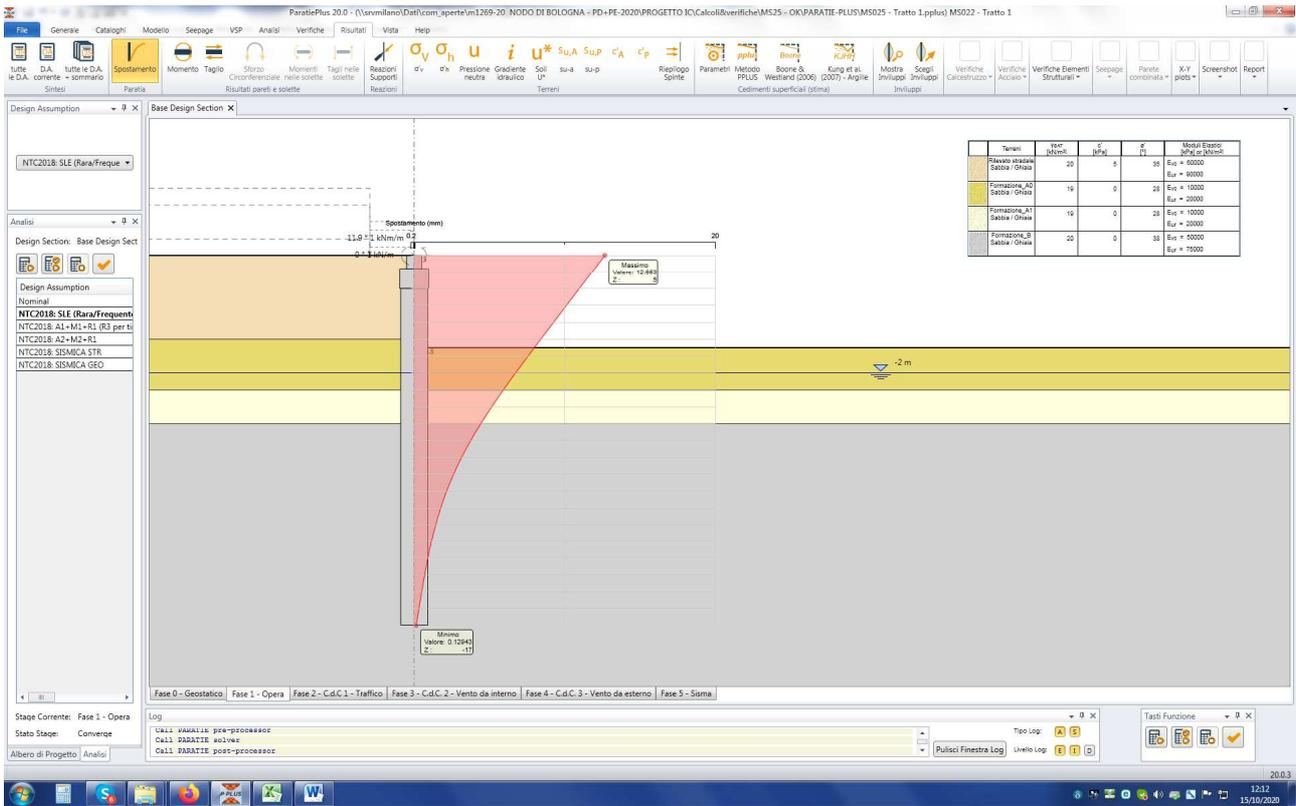
Figura n.8.7 – Spostamenti fase 2 fine costruzione
