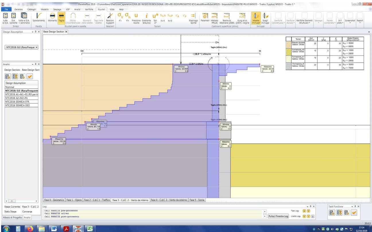
Figura n. 10.16 – Azione di taglio - Inviluppo SLU
