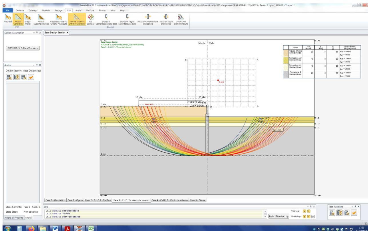
Figura n.11.1 – Analisi di stabilità – Configurazione finale – Verifica statica
