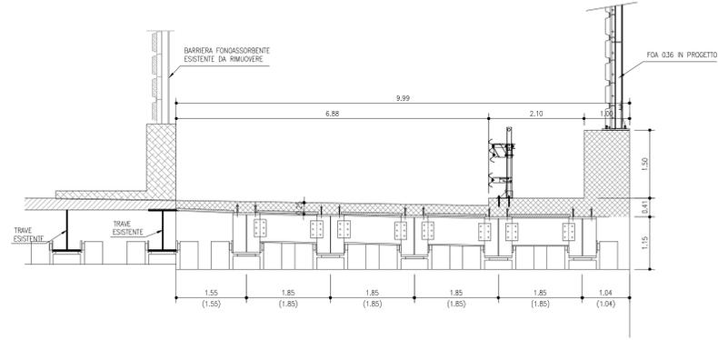
SEZIONE TRASVERSALE TRAVERSO SPALLA LATO RIMINI IMPALCATO AMPLIAMENTO LATO NORD
