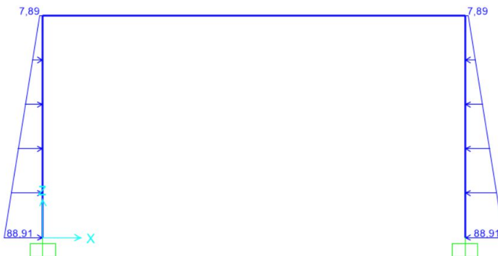
Figura 3-3 – Spinta delle terre sui piedritti
