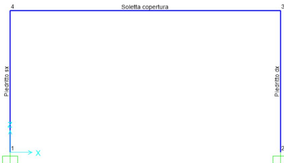
Figura 3-1 – Modello di calcolo ad elementi finiti
