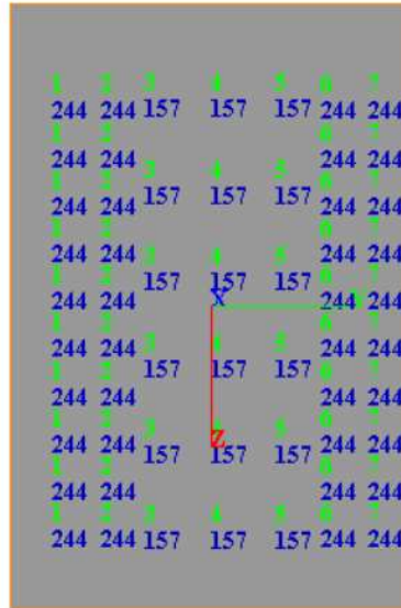
Figura 8-8. Azioni assiali di calcolo sulla palificata - SLU
