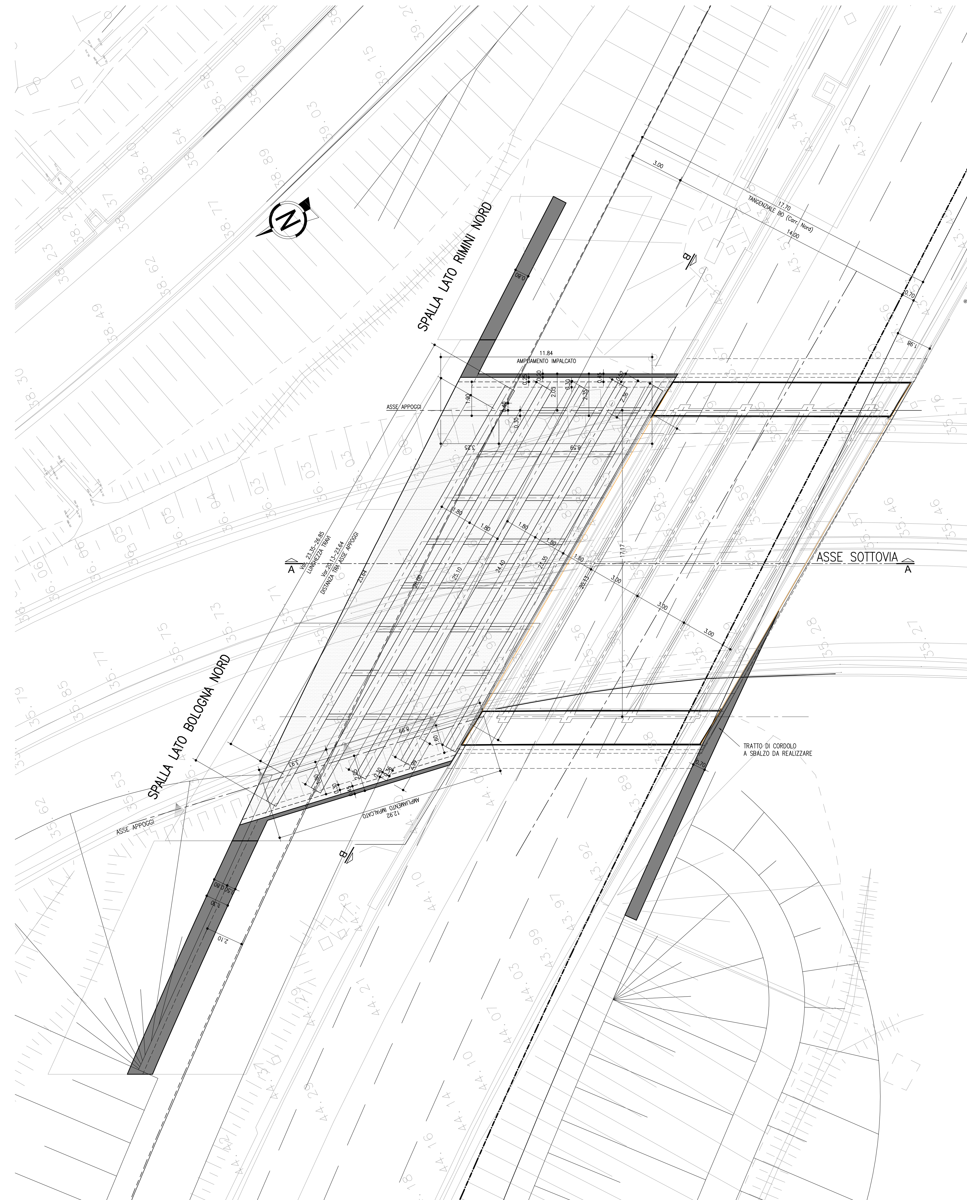
PIANTA IMPALCATO SCALA 1:100
