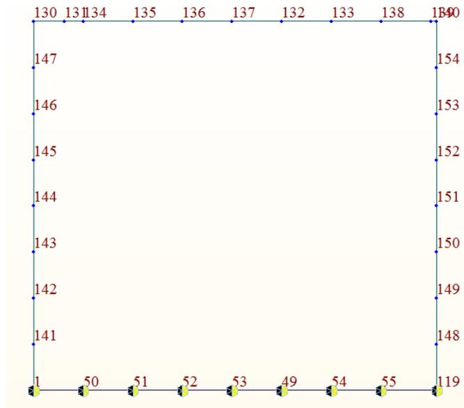
Figura 25 Vincoli applicati al modello a elementi finiti dello scatolare
