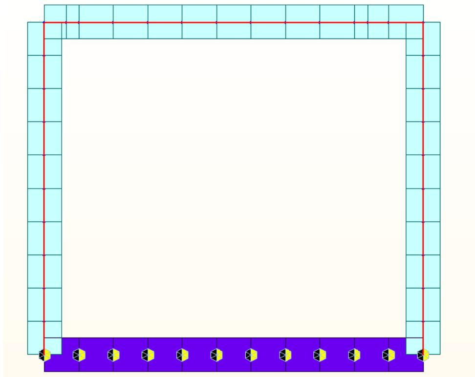
Figura 9 Vincoli applicati al modello a elementi finiti dello scatolare
