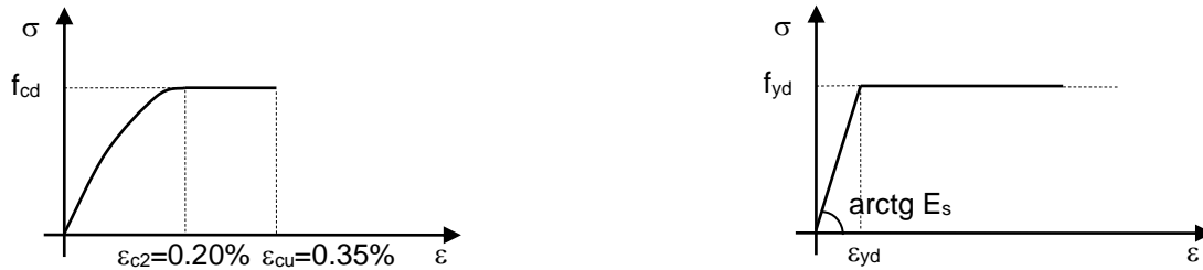
Legame costitutivo parabola-rettangolo per il calcestruzzo e legame costitutivo elastico-perfettamente plastico per l'acciaio.
