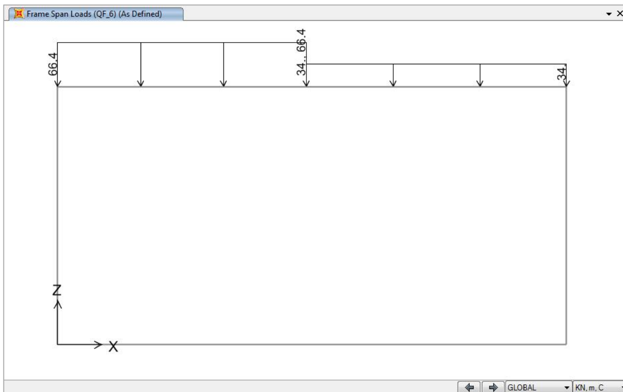
Figura 2-11: Carichi mobili dovuti al traffico ferroviario - Q_F6
