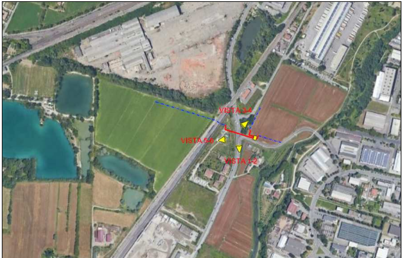
Figura 14 - Ortofoto con tracciato metanodotto esistente e indicazione dei punti di vista tracciato; in azzurro il tracciato del metanodotto esistente, in rosso il nuovo tratto in variante; nel riquadro giallo il punto di inserimento del PIDI n. 24/86
