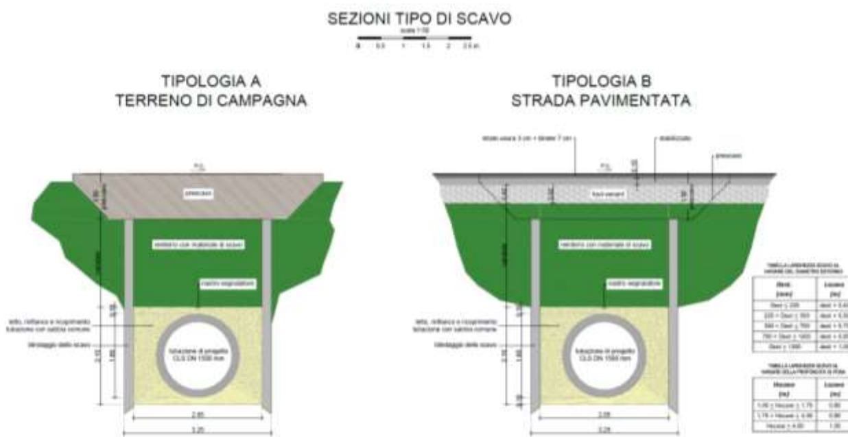
Figura 3 - Sezioni tipo di scavo
