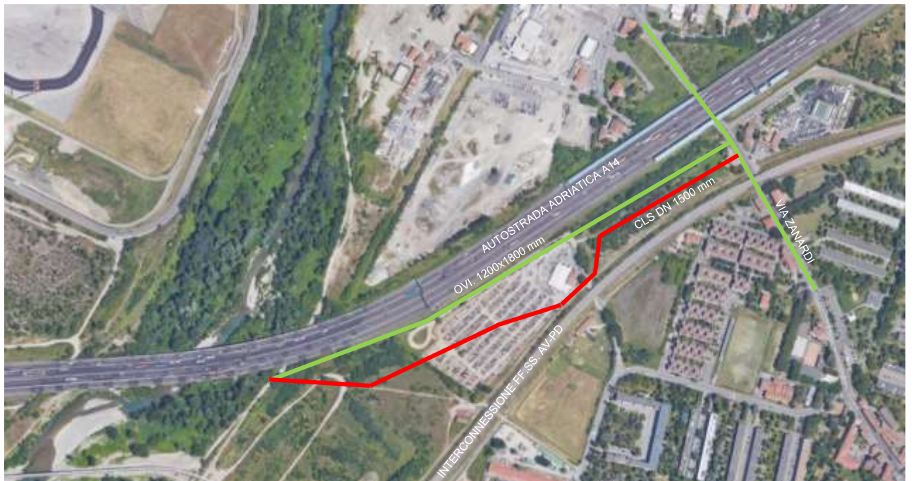
Figura 2 – Intervento di spostamento FOG 028 – 1/2/3 su base ortofoto
