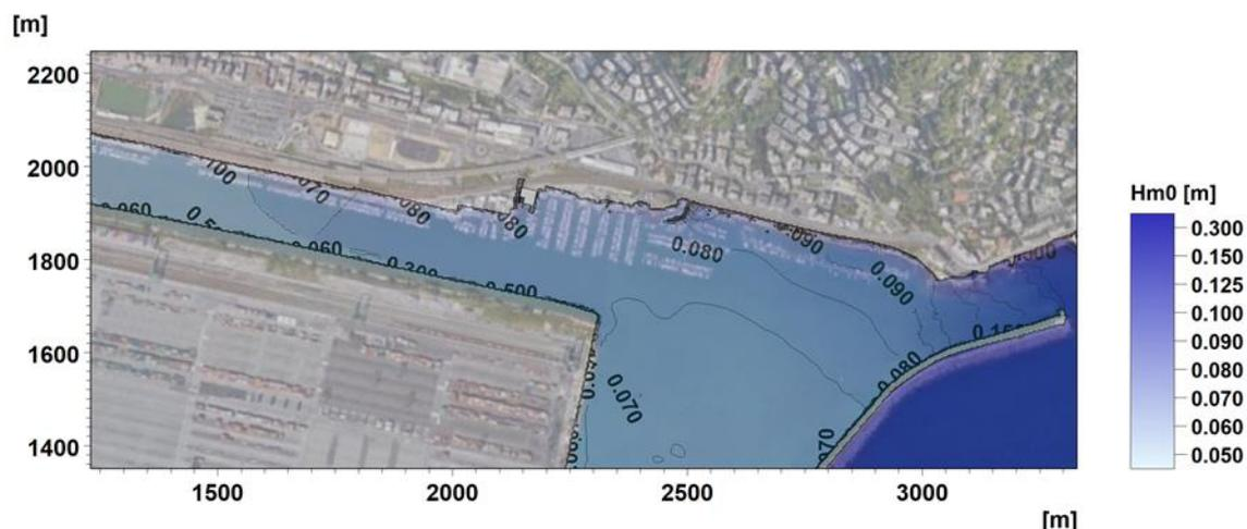
Figura 8-6 Onda TR 5 anni ( $H_s=3.75\text{m}$ ;  $T_p=10.5\text{s}$ ;  $MWD=170^\circ\text{N}$ ): dettaglio della distribuzione dell'onda residua sulla zona oggetto dell'intervento in progetto
