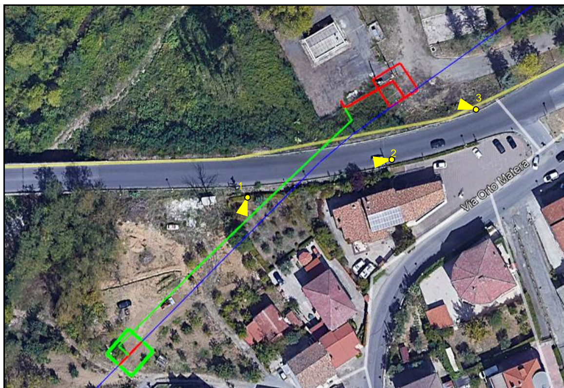
Fig. 2.4.2/E – Opere in progetto e dismissione con punti di ripresa fotografica (tracciato di progetto in rosso, dismissione in verde)
