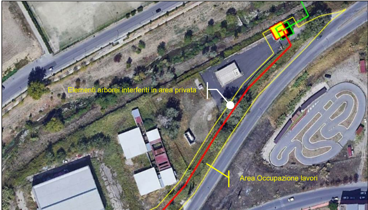
Fig. 2.7/C – Rif. All. Comune di Cosenza, parte terminale del Tracciato in progetto (rosso) ed aree di lavoro. Interferenza con elementi arborei in area privata.
