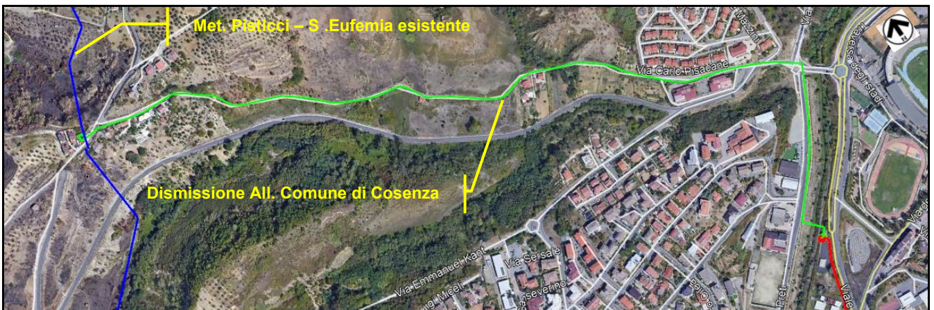
Figura 2.1/G – Quadro paesaggistico su immagine aerea con localizzazione interventi All. Comune di Cosenza (in rosso tracciato in progetto, in verde dismissione, in blu esistente)
