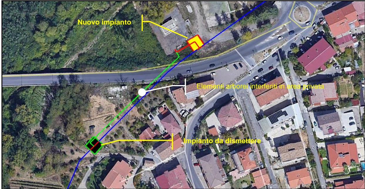
Figura 2.1/F – Quadro paesaggistico su immagine aerea con localizzazione Intervento All. Comune di Rendone (in rosso tracciato in progetto, in verde dismissione, in blu esistente)
