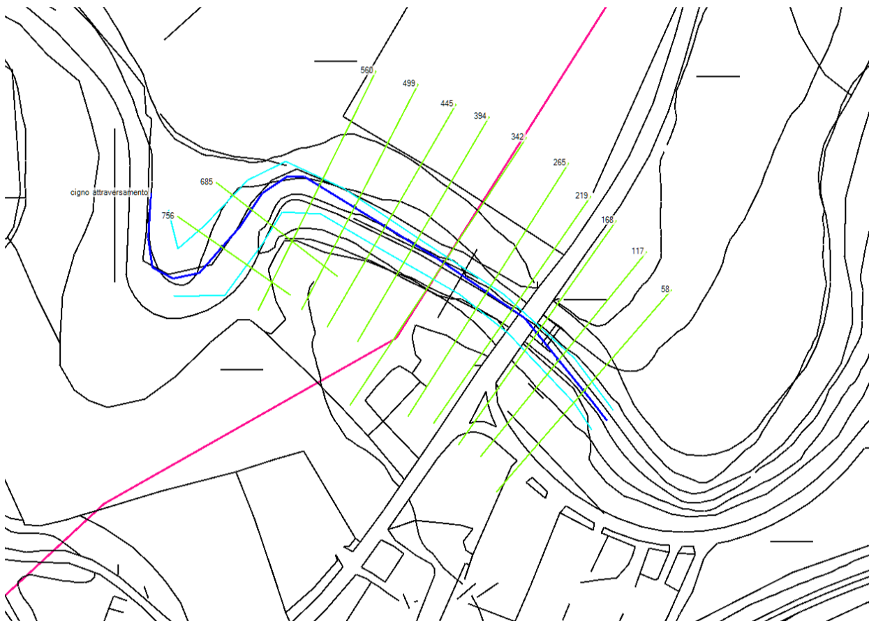
Fig.5.2/A: Foto aerea, con tronco d'alveo analizzato e sezioni di input
