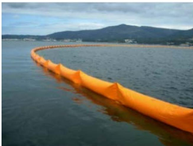
Figura 15: Esempio di utilizzo di barriera galleggiante antinquinamento (Immagini di proprietà di CSA Distribuzione srl)
