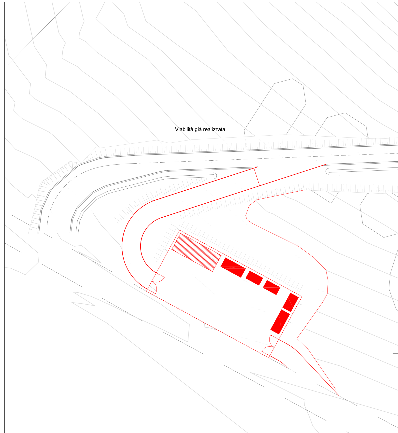
Fase 1 - Installazione campo base monte - 1:200
