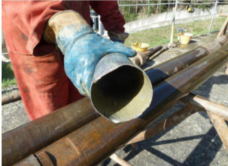
Alla profondità di 22,30 m si ritiene che inizi il basamento con la presenza di Pietraforte che in alcuni tratti si presenta massiva in altri fratturata, con probabile stratificazione subverticale che crea difficoltà all'avanzamento del carotiere.
