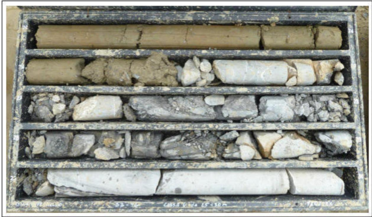
Fig. 9 – Estratto della stratigrafia del sondaggio S3-16 eseguito nella campagna di indagine del 2016 (cassetta catalogatrice da -25 m da p.c a -30 m da p.c).
