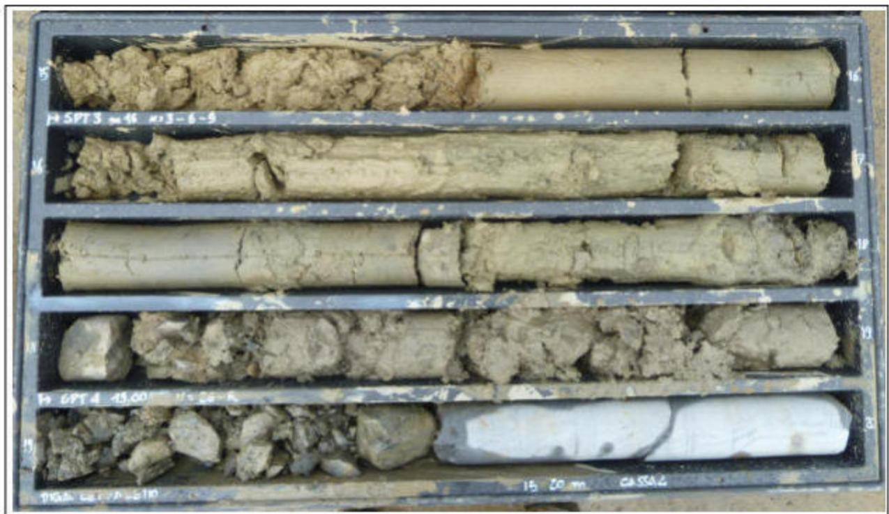
Fig. 11 – Estratto della stratigrafia del sondaggio S5-16 eseguito nella campagna di indagine del 2016 (cassetta catalogatrice da -15 m da p.c a -20 m da p.c).
