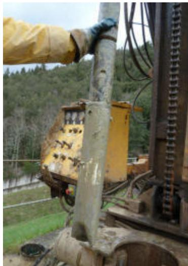
Alla profondità di 19,00 m si ritiene che inizi il basamento con la presenza di livelli siltitici e Pietraforte, che in alcuni tratti si presenta massiva in altri fratturata, con probabile stratificazione subverticale che crea difficoltà all'avanzamento del carotiere.
