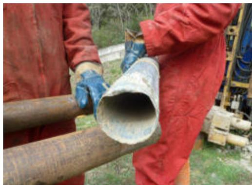
Alla profondità di 7,50 m si ritiene che inizi il basamento con la presenza di livelli siltitici e Pietraforte, che in alcuni tratti si presenta massiva in altri fratturata, con probabile stratificazione subverticale che crea difficoltà all'avanzamento del carotiere.
