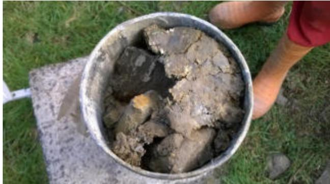
I valori ottenuti con penetrometro tascabile (pocket penetrometer) nei livelli coesivi delle carote non sono stati ritenuti attendibili a causa della presenza diffusa e continua di ghiaietto.
