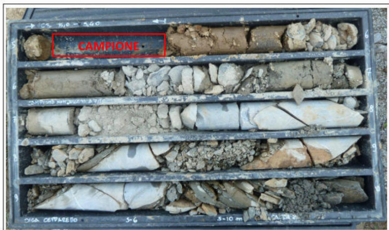
Fig. 12 – Estratto della stratigrafia del sondaggio S6-16 eseguito nella campagna di indagine del 2016 (cassetta catalogatrice da -10 m da p.c a -15 m da p.c).
